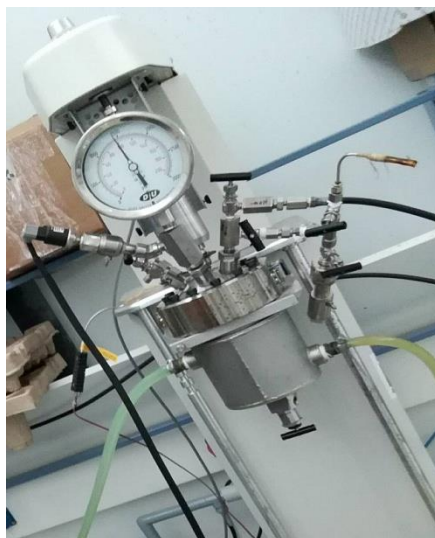
Εικόνα 13 : Αντιδραστήρας υψηλής πίεσης της Parr Instruments Company, μοντέλο 4525
