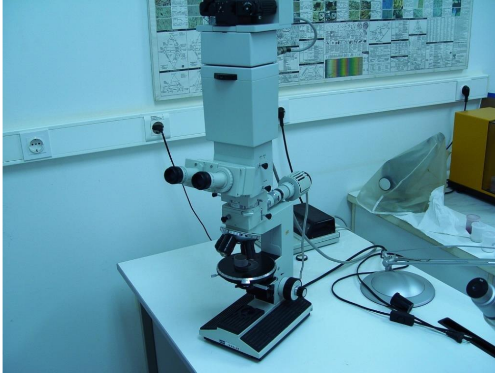
Εικόνα 3.1: Μικροσκόπιο διερχόμενου και ανακλώμενου φωτός του Εργαστηρίου Γενικής και Τεχνικής Ορυκτολογίας του Πολυτεχνείου Κρήτης.
