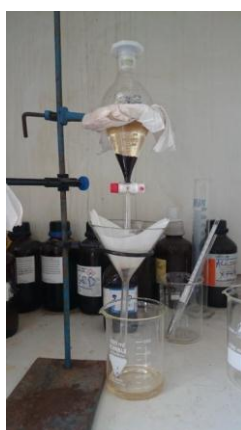
Εικόνα 3.8: Τμήμα διάταξης βαρυτομετρικού διαχωρισμού, το σκουρόχρωμο υλικό είναι το βαρύ υλικό.
