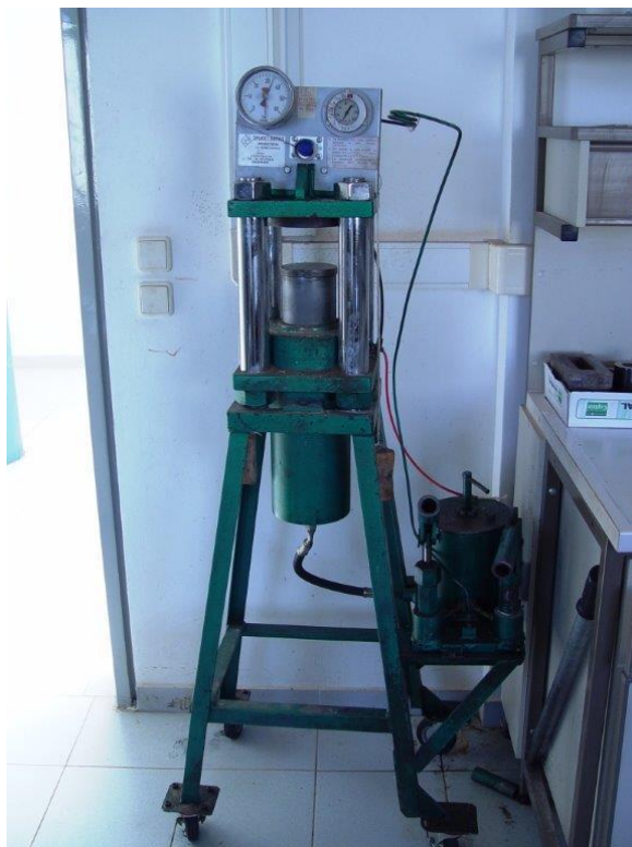
Εικόνα 3.7: Υδραυλική πρέσα για κατασκευή ταμπλέτας για XRF
