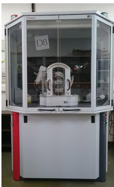
Εικόνα 3.2: Περιθλασίμετρο ακτίνων-X (XRD) του Εργαστηρίου Γενικής και Τεχνικής Ορυκτολογίας του Πολυτεχνείου Κρήτης.
