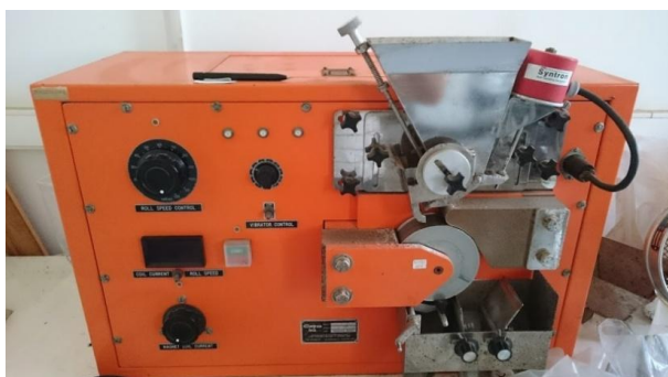
Εικόνα 3.10: Ξηρός μαγνητικός διαχωριστής υψηλής έντασης.
