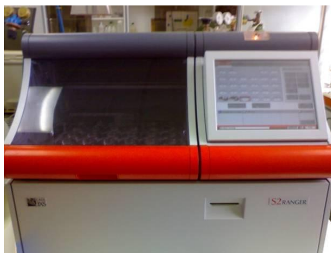
Εικόνα 3.5: Φασματοσκόπιο ακτίνων-X φθορισμού του Εργαστηρίου Ανόργανης Γεωχημείας, Οργανικής Γεωχημείας και Οργανικής Πετρογραφίας του Πολυτεχνείου Κρήτης.
