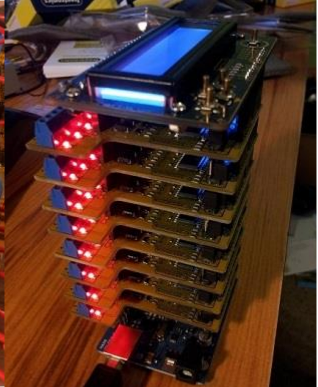
Εικόνα 2.9 Σύνδεση 64 ρελέ (relay) και LCD εικόνας με Shield [22]
