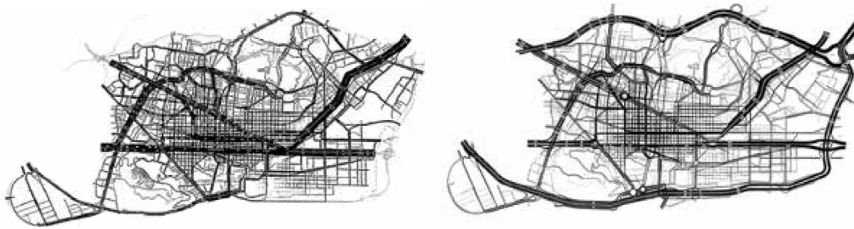
Κυκλοφοριακός φόρτος πριν και μετά την κατασκευή των περιφερειακών οδών
