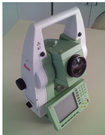
Εικόνα68. reflectorless ψηφιακός ολοκληρωμένος γεωδαιτικός σταθμός TCR 1201 Πηγή: (Τσιτσιμπλάμης, 2016)
