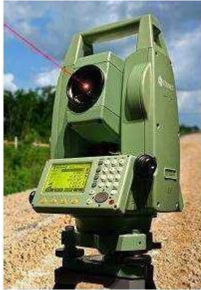
Εικόνα 67. Ο Ψηφιακός ολοκληρωμένος γεωδαιτικός σταθμός stonex STS Πηγή: (Τσιτσιμπλάμης, 2016)
