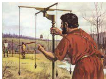
Εικόνα 4. Ο αρχαιοελληνικός «αστέρας» για τη μέτρηση και χάραξη ορθών γωνιών.
