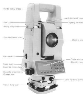
Εικόνα 50. Ηλεκτρονικό ταχύμετρο
