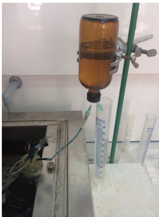
Εικόνα 6. Βύθιση αντιδραστήρων σε υδατόλουτρο και ογκομέτρηση μεθανίου με εκτόπιση NaOH
