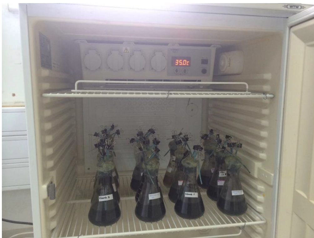
Εικόνα 5. Αναερόβια χώνευση των αντιδραστήρων εντός του επωαστήρα
