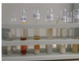
Εικόνα 167: α, β, γ) Δοκιμαστικοί σωλήνες με τα διαλύματα των κονιών και την προσθήκη HCl και NaOH.
