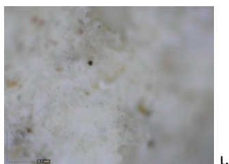
Εικόνα 175: Παρουσία αλάτων σε κονιάματα δομής μετά την εφαρμογή του SurfaPore FX WB, α) δείγμα KN2b, β) δείγμα KN5b, γ) δείγμα KN7b, δ) δείγμα KN14b, ε) δείγμα KN15b, στ) KN21b, ζ) KN31b, η) KN34b, θ) KN35b, ι) KN39b
