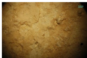
Εικόνα 76: Φωτογραφική απεικόνιση δείγματος ΚΝ21 α) από στερεοσκόπιο - κονίαμα δομής, β) από ψηφιακό μικροσκόπιο - κονίαμα δομής, γ) από στερεοσκόπιο - επιχρίσμα, δ1, δ2) από ψηφιακό μικροσκόπιο - επιχρίσμα.
