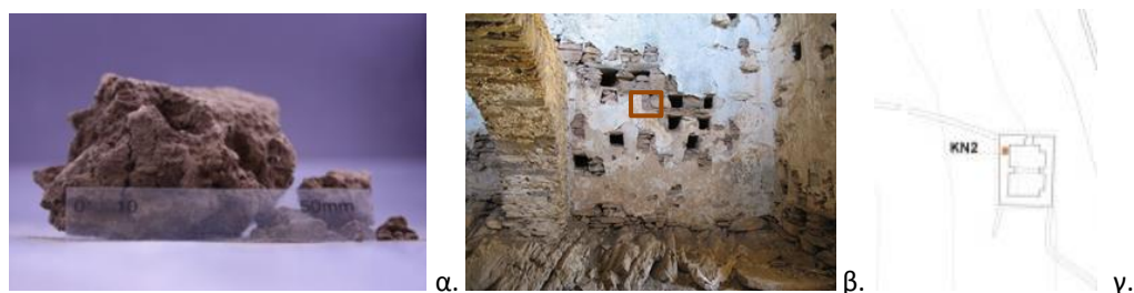
Εικόνα 22: Φωτογραφική και σχεδιαστική απεικόνιση δείγματος KN2: α) Μακροσκοπική φωτογράφιση, β) Σχέση σημείου στο χώρο, γ) Σχέση σημείου δειγματοληψίας σε κάτοψη
