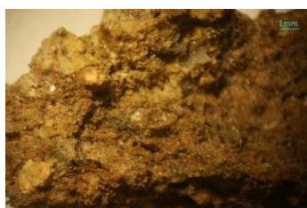
Εικόνα 66: Φωτογραφική απεικόνιση δείγματος KN7 α1, α2) από στερεοσκόπιο- κονίαμα δομής, β) από ψηφιακό μικροσκόπιο - κονίαμα δομής.
