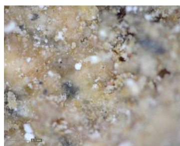
Εικόνα 65: Φωτογραφική απεικόνιση δείγματος KN5 α1, α2) από στερεοσκόπιο - κονίαμα δομής, β1, β2) από ψηφιακό μικροσκόπιο - κονίαμα δομής
