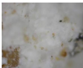
Εικόνα 70: Φωτογραφική απεικόνιση δείγματος ΚΝ14 α) από στερεοσκόπιο- κονίαμα δομής, β1, β2) από ψηφιακό μικροσκόπιο-κονίαμα δομής
