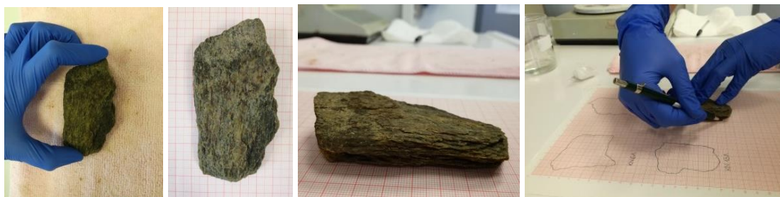
Εικόνα 6: Διαδικασία υπολογισμού της επιφάνειας των ακανόνιστων δειγμάτων.
