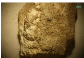
Εικόνα 77: Φωτογραφική απεικόνιση δείγματος KN22 α1, α2) από στερεοσκόπιο - κονίαμα δομής, β) από ψηφιακό μικροσκόπιο - κονίαμα δομής.
