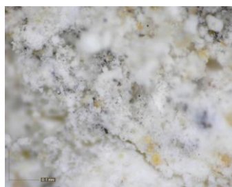
Εικόνα 67: Φωτογραφική απεικόνιση δείγματος KN8 α1, α2) από στερεοσκόπιο - κονίαμα δομής, β1, β2) από ψηφιακό μικροσκόπιο - κονίαμα δομής.
