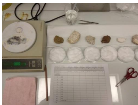
Εικόνα 182: α) Στιγμιότυπο από την πειραματική διαδικασία της τριχοειδούς αναρρίχησης πριν την έναρξη της, β) Απεικόνιση ορισμένων δειγμάτων κατά την διαδικασία της τριχοειδούς αναρρίχησης.
