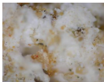
Εικόνα 88: Φωτογραφική απεικόνιση δείγματος ΚΝ35 α1, α2) από στερεοσκόπιο - κονίαμα δομής, β1, β2) από ψηφιακό μικροσκόπιο - κονίαμα δομής.
