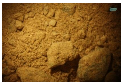
Εικόνα 82: Φωτογραφική απεικόνιση δείγματος KN29 α) από στερεοσκόπιο - κονίαμα δομής, β) από ψηφιακό μικροσκόπιο - κονίαμα δομής
