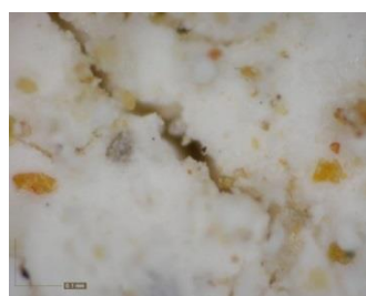
Εικόνα 83: Φωτογραφική απεικόνιση δείγματος KN30 α1, α2) από στερεοσκόπιο - κονίαμα δομής, β) από ψηφιακό μικροσκόπιο - κονίαμα δομής, γ1, γ2) από στερεοσκόπιο - επίχρισμα, δ1, δ2, δ3) από ψηφιακό μικροσκόπιο - επίχρισμα.
