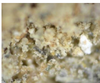
Εικόνα 82: Φωτογραφική απεικόνιση δείγματος KN29 α) από στερεοσκόπιο - κονίαμα δομής, β) από ψηφιακό μικροσκόπιο - κονίαμα δομής
