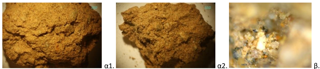
Εικόνα 73: Φωτογραφική απεικόνιση δείγματος ΚΝ17 α1, α2) από στερεοσκόπιο - κονίαμα δομής, β) από ψηφιακό μικροσκόπιο - κονίαμα δομής
