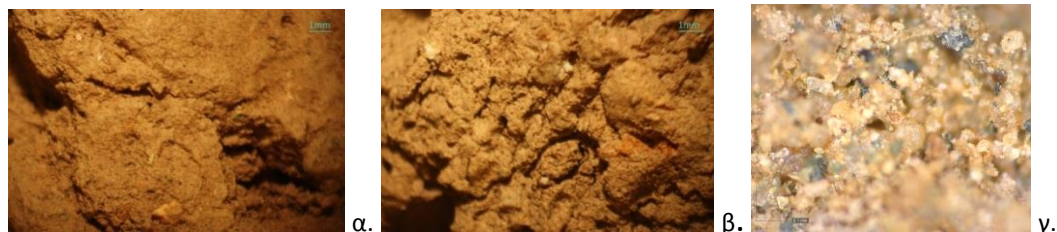
Εικόνα 62: Φωτογραφική απεικόνιση δείγματος KN2 α, β ) από στερεοσκόπιο, γ) από ψηφιακό μικροσκόπιο οπτικών ινών
