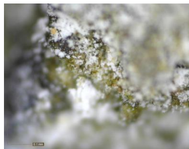
Εικόνα 80: Φωτογραφική απεικόνιση δείγματος KN27 α1, α2) από στερεοσκόπιο - κονίαμα δομής, β1, β2) από ψηφιακό μικροσκόπιο - κονίαμα δομής
