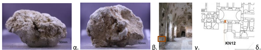
Εικόνα 32: Φωτογραφική απεικόνιση δείγματος KN12: α, β) Μακροσκοπική φωτογράφιση κονιάματος δομής KN12, γ) Σχέση σημείου στο χώρο, δ) Σχέση σημείου δειγματοληψίας σε κάτοψη
