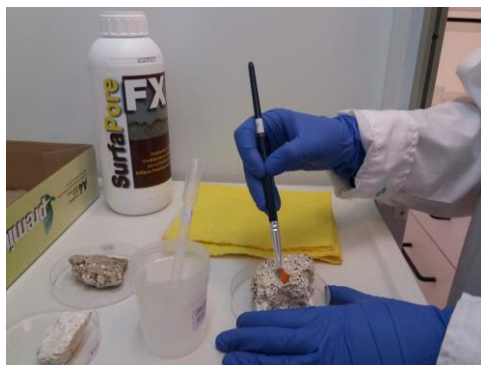
Εικόνα 169: Διαδικασία εφαρμογής νανοσύνθετου υλικού SurfaPore FX WB με πινέλο.
