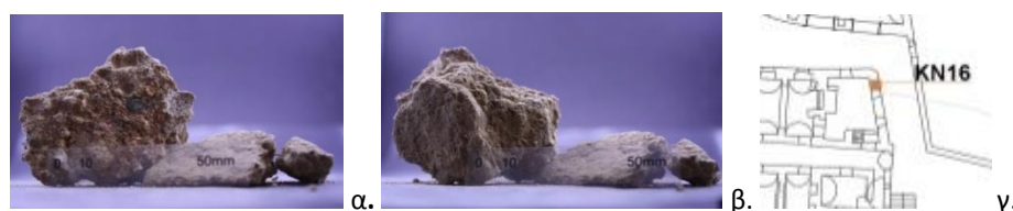
Εικόνα 36: Φωτογραφική απεικόνιση δείγματος KN16: α) Μακροσκοπική φωτογράφιση κονιάματος επιχρίσματος β) μακροσκοπική φωτογράφιση κονιάματος δομής, γ) Σχέση σημείου στο χώρο
