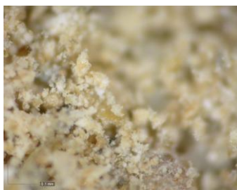
Εικόνα 79: Φωτογραφική απεικόνιση δείγματος KN25 α1, α2) από στερεοσκόπιο - κονίαμα δομής, β1, β2) από ψηφιακό μικροσκόπιο - κονίαμα δομής
