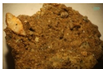
Εικόνα 66: Φωτογραφική απεικόνιση δείγματος KN7 α1, α2) από στερεοσκόπιο- κονίαμα δομής, β) από ψηφιακό μικροσκόπιο - κονίαμα δομής.
