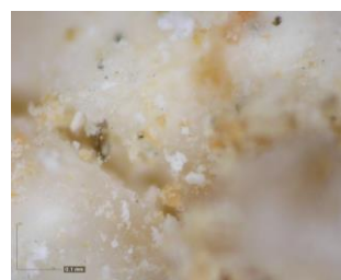
Εικόνα 90: Φωτογραφική απεικόνιση δείγματος ΚΝ37 α1, α2, α3) από στερεοσκόπιο - κονίαμα δομής, β1, β2) από ψηφιακό μικροσκόπιο - κονίαμα δομής.
