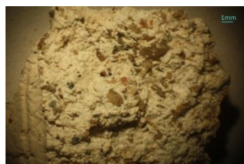
Εικόνα 70: Φωτογραφική απεικόνιση δείγματος ΚΝ14 α) από στερεοσκόπιο- κονίαμα δομής, β1, β2) από ψηφιακό μικροσκόπιο-κονίαμα δομής
