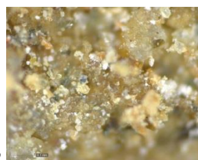
Εικόνα 66: Φωτογραφική απεικόνιση δείγματος KN7 α1, α2) από στερεοσκόπιο- κονίαμα δομής, β) από ψηφιακό μικροσκόπιο - κονίαμα δομής.
