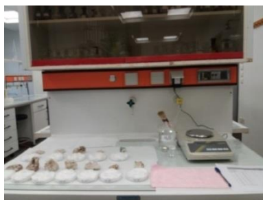
Εικόνα 4: Προετοιμασία δοκιμίων πριν την έναρξη της πειραματικής διαδικασίας της τριχοειδούς αναρρίχησης
