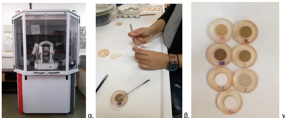
Εικόνα 1: α) Περιθλασίμετρο ακτίνων Χ, β) Διαδικασία προετοιμασίας των φορέων, γ) Δειγματοφορείς κονιαμάτων
