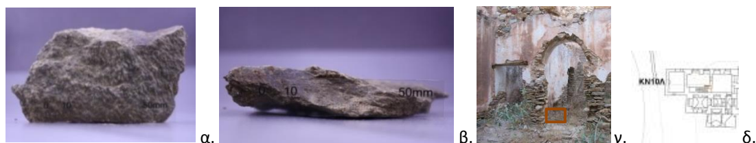
Εικόνα 30: Φωτογραφική απεικόνιση δείγματος KN10Λ: α, β) Μακροσκοπική φωτογράφιση του λιθόσωματος KN10Λ, γ) Σχέση σημείου στο χώρο, δ) Σχέση σημείου δειγματοληψίας σε κάτοψη
