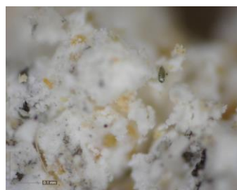
Εικόνα 67: Φωτογραφική απεικόνιση δείγματος KN8 α1, α2) από στερεοσκόπιο - κονίαμα δομής, β1, β2) από ψηφιακό μικροσκόπιο - κονίαμα δομής.
