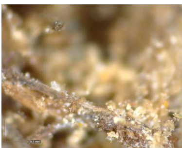
Εικόνα 78: Φωτογραφική απεικόνιση δείγματος ΚΝ23 α1, α2) από στερεοσκόπιο - κονίαμα δομής, β1, β2) από ψηφιακό μικροσκόπιο - κονίαμα δομής
