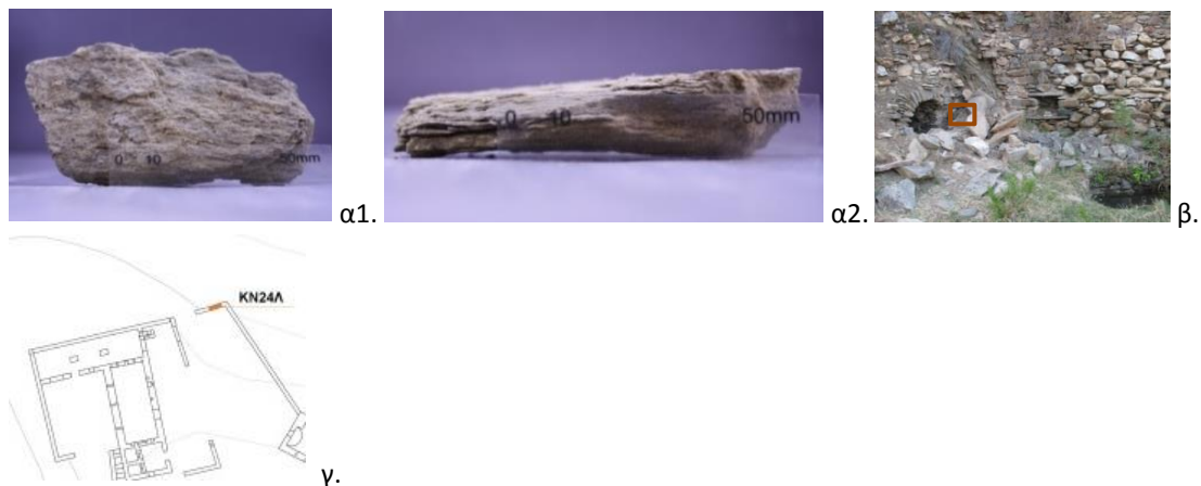
Εικόνα 44: Φωτογραφική απεικόνιση δείγματος KN24Λ: α1, α2) Μακροσκοπική φωτογράφιση λιθοσώματος KN24Λ, β) Σχέση σημείου στο χώρο, γ) Σχέση σημείου δειγματοληψίας σε κάτοψη
