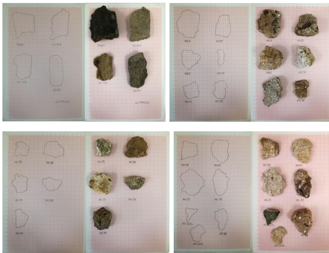
Εικόνα 7: Φωτογραφική τεκμηρίωση μέτρησης επιφάνειας ορισμένων δειγμάτων σε χιλιοστομετρικό χαρτί.
