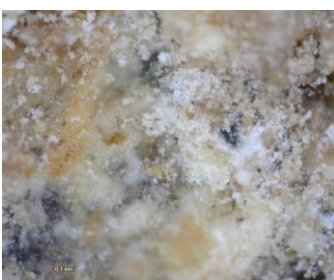
Εικόνα 65: Φωτογραφική απεικόνιση δείγματος KN5 α1, α2) από στερεοσκόπιο - κονίαμα δομής, β1, β2) από ψηφιακό μικροσκόπιο - κονίαμα δομής
