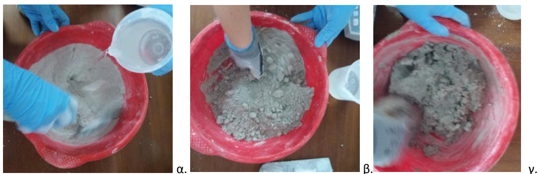
Εικόνα 199: α, β, γ) Διαδικασία παρασκευής κονιάματος επιχρίσματος, σύνθεσης Ε1, στάδιο ανάμιξης σε λεκάνη.
