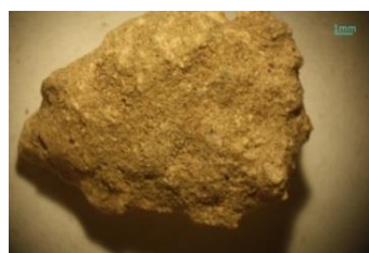
Εικόνα 77: Φωτογραφική απεικόνιση δείγματος KN22 α1, α2) από στερεοσκόπιο - κονίαμα δομής, β) από ψηφιακό μικροσκόπιο - κονίαμα δομής.
