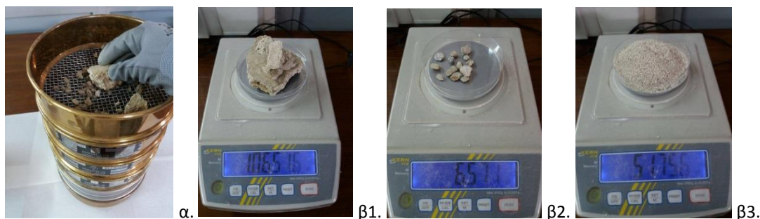
Εικόνα 93: α) Διαδικασία Κοκκομετρικής διαβάθμισης κονιαμάτων, β1, β2, β3) Διαδικασίας ζύγισης δείγματος των συγκρατούμενων αδρανών.
