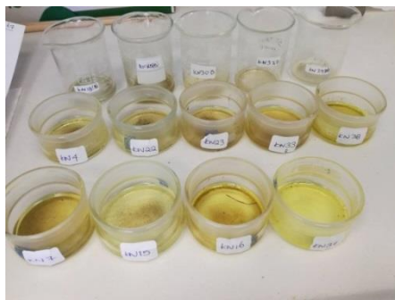
Εικόνα 166: Διαλύματα των δειγμάτων διαλυμένα σε HCl.
