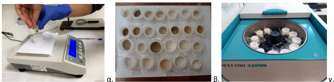
Εικόνα 2: Προετοιμασία δειγμάτων για EDXRF: α) Ζύγισμα της κονίας, β) Δειγματοφορείς πριν την εισαγωγή στο μηχάνημα, γ) Φασματομέτρο
