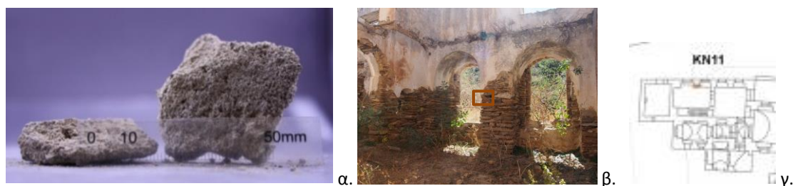
Εικόνα 31: Φωτογραφική απεικόνιση δείγματος KN11: α) Μακροσκοπική φωτογράφιση κονιάματος επιχρίσματος KN11, β) Σχέση σημείου στο χώρο, γ) Σχέση σημείου δειγματοληψίας σε κάτοψη
