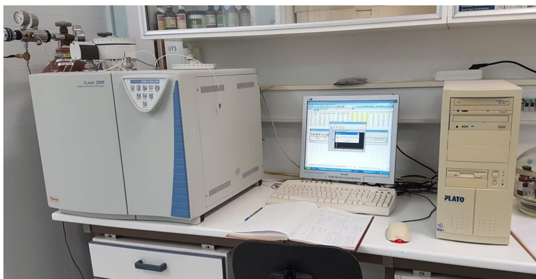
Σχήμα 3.4 : Αυτόματος Στοιχειακός Αναλυτής Flash 2000 Series, της εταιρείας ThermoFisherScientific.
