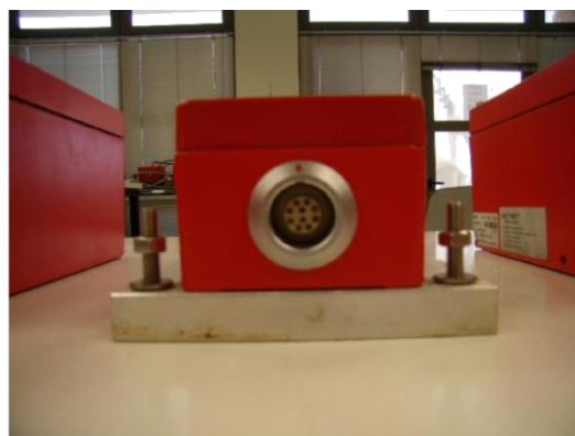
Εικόνα 4.1: Αισθητήρες επιτάχυνσης «MS» πάνω όψη & πλάγια όψη όπου φαίνεται η υποδοχή του καλωδίου σύνδεσης
