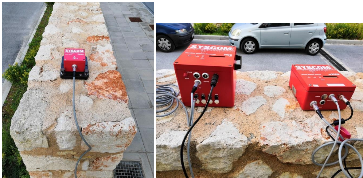
Εικόνα 4.23: Τοποθέτηση επιταχυνσιογράφου και σύνδεση με καταγραφέα
