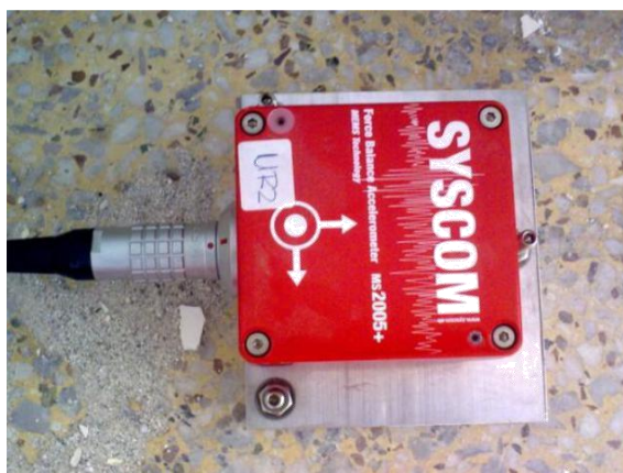
Εικόνα 4.1: Αισθητήρες επιτάχυνσης «MS» πάνω όψη & πλάγια όψη όπου φαίνεται η υποδοχή του καλωδίου σύνδεσης
