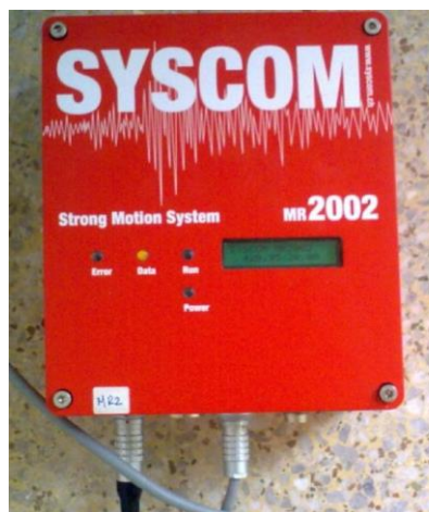
Εικόνα 4.7: Συσκευή καταγραφικού «MR», πάνω όψη και πλάγια όψη όπου φαίνονται οι υποδοχές των καλωδίων σύνδεσης.
