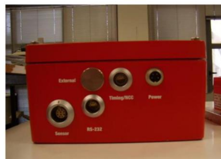
Εικόνα 4.7: Συσκευή καταγραφικού «MR», πάνω όψη και πλάγια όψη όπου φαίνονται οι υποδοχές των καλωδίων σύνδεσης.
