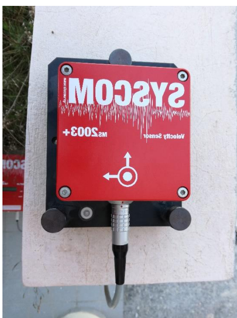
Εικόνα 4.13: Τοποθέτηση επιταχυνσιογράφου και σύνδεση με υπολογιστή.
