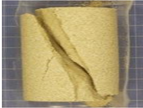
Εικόνα 28: Φωτογραφία του θραυσμένου δοκιμίου ψαμμίτη Castlegate σε ανεμπόδιση θλίψη σε ξηρές συνθήκες.
