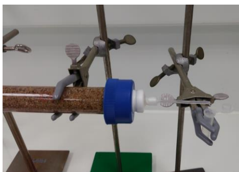
Εικόνα 2.4: Στιγμιότυπο κατά την συλλογή δείγματος, σε φιαλίδιο erpendorf, στην έξοδο της στήλης.
