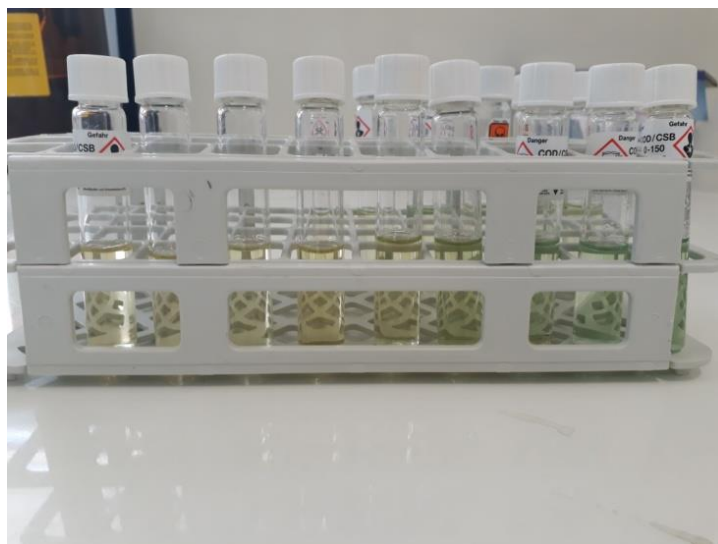
Εικόνα 27: Φιαλίδια με εμφανή τον σχηματισμό της έγχρωμης ένωσης της ανθρόνης με τα προϊόντα πέψης των υδατανθράκων.
