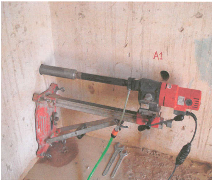
Εικόνα 26 Δειγματοληψία στη θέση Α και Β στο εσωτερικό του πύργου(πηγή: Τεχνική υπηρεσία Δήμου Χανίων)
