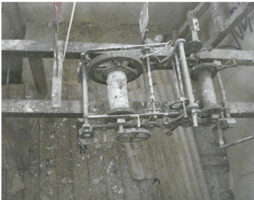
Εικόνα 13 Ο μηχανισμός του Ρολογιού (πηγή Τεχνική υπηρεσία Δήμου Χανίων)
