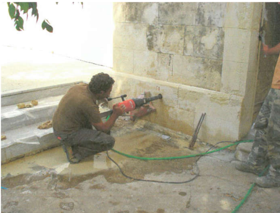
Εικόνα 25 Δειγματοληψία στη θέση Γ (πηγή: Τεχνική υπηρεσία Δήμου Χανίων)
