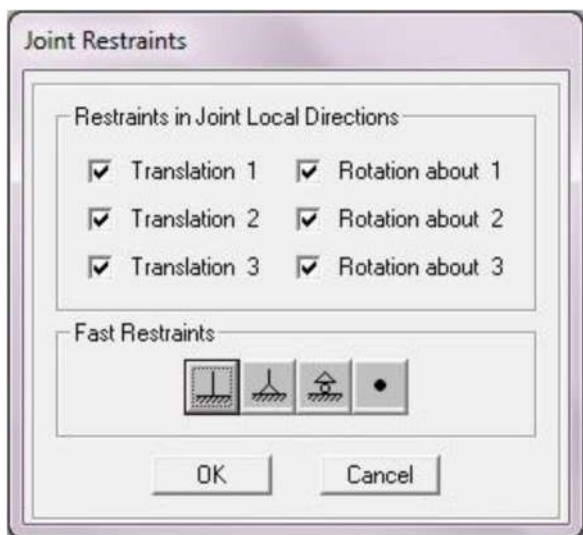
Εικόνα 49 Εισαγωγή στηρίξεων στο SAP2000
