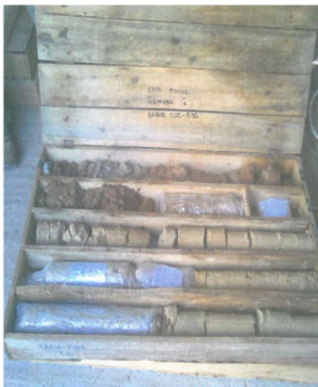
Εικόνα 38 Διατρήματα γεώτρησης από 0 έως 5,30μ και 5,30μ έως 10,00μ βάθος αντίστοιχα (πηγή: Τεχνική υπηρεσία Δήμου Χανίων)
