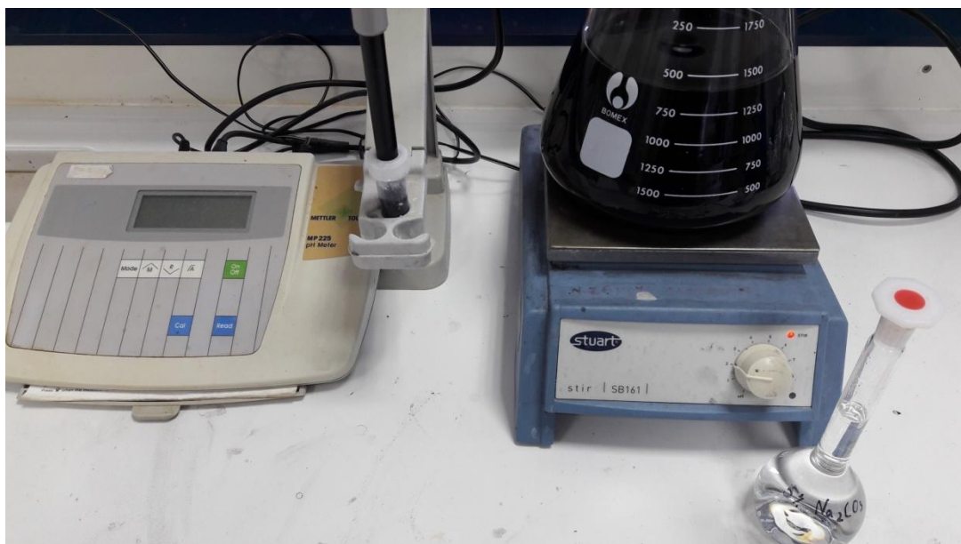
Εικόνα 3.18: Προσθήκη του διαλύματος \text{Na}_2\text{CO}_3 5% στο υδατικό αιώρημα οξειδίου του γραφενίου καθώς και το πεχάμετρο που έγινε η μέτρηση του pH.
