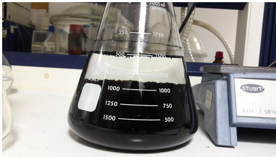
Εικόνα 3.16: Καθίζηση του αναγμένου οξειδίου του γραφενίου στο διάλυμα.
