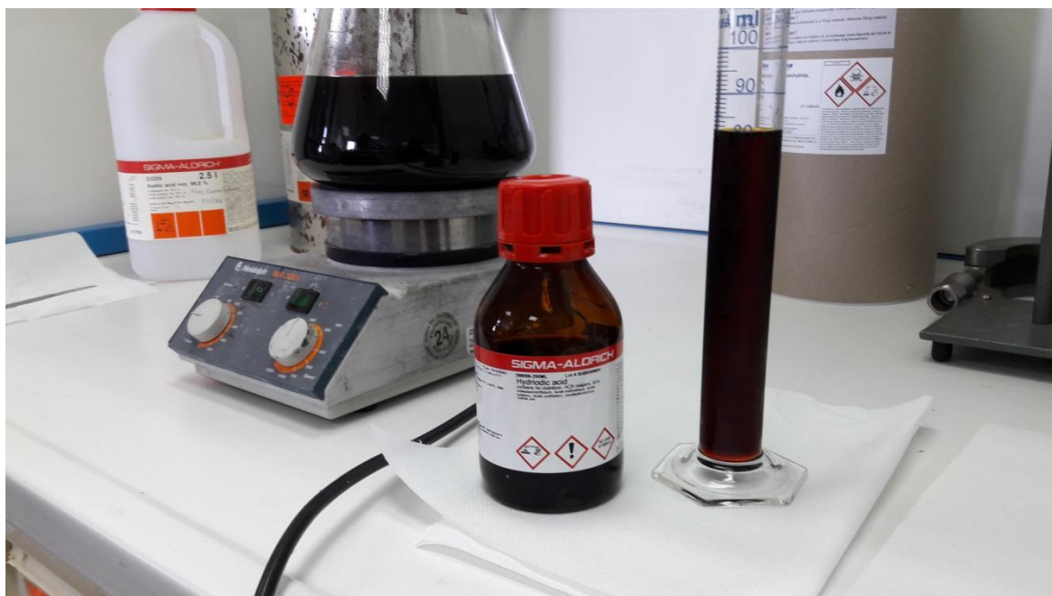
Εικόνα 3.22: Διάλυμα 1,2 L οξικού οξέος με 2,63g GO#1-ex και τα 80mL HI στην ογκομετρική φιάλη.
