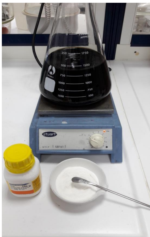
Εικόνα 3.15: Προσθήκη ασκορβικού οξέος σε 1,5L υδατικού αιωρήματος οξειδίου του γραφενίου.
