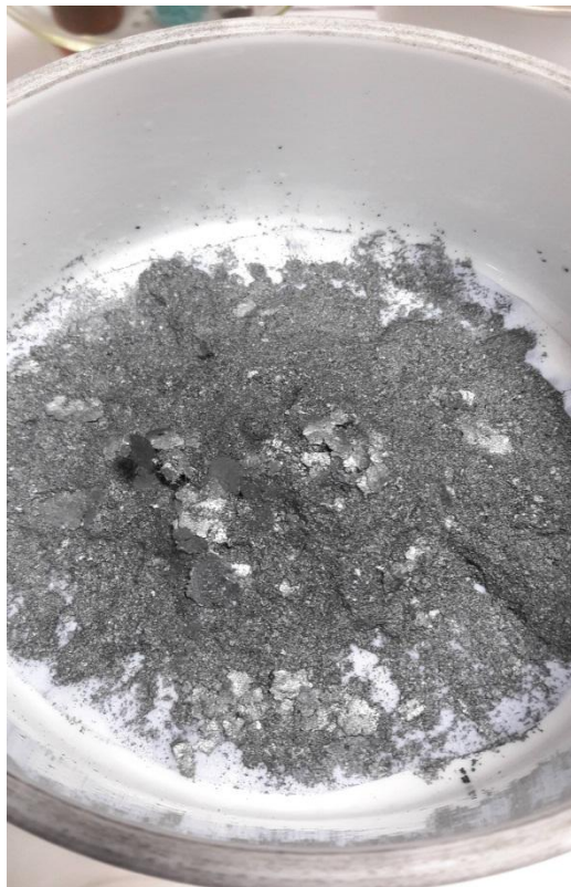
Εικόνα 3.25: Το αναγμένο οξείδιο του γραφενίου που έμενε πάνω στο διηθητικό χαρτί από τις πλύσεις με το νερό
