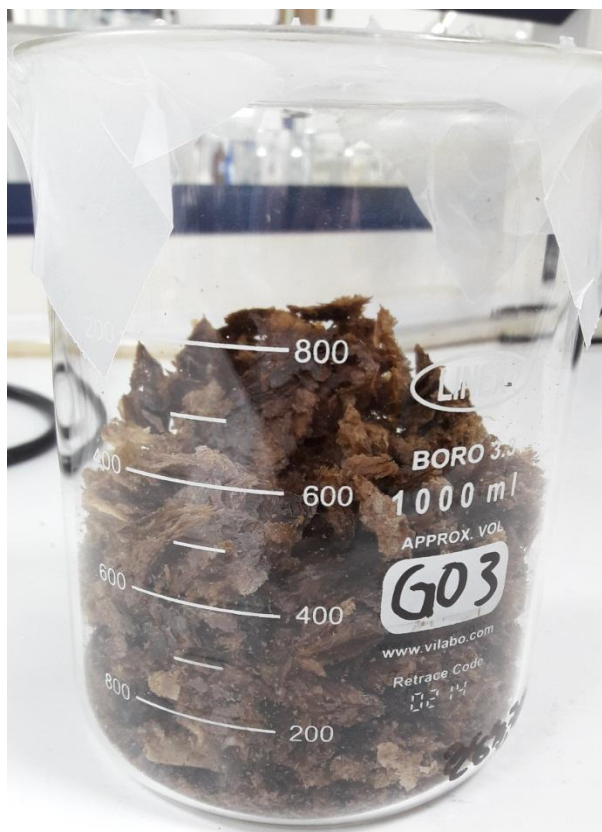
Εικόνα 3.14: Το GO#3 που προέκυψε από το freeze dryer.
