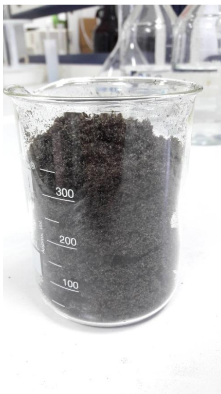
Εικόνα 3.21: Το GO#1-ex που προέκυψε μετά την ξήρανση του 1,5L υδατικού αιωρήματος οξειδίου του γραφενίου.
