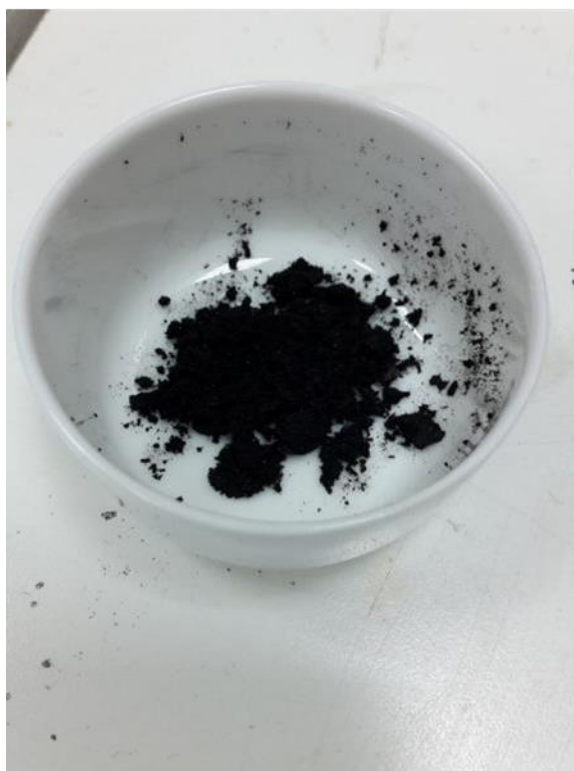
Εικόνα 3.17: Το αναγμένο οξείδιο του γραφενίου μετά το freeze drying.
