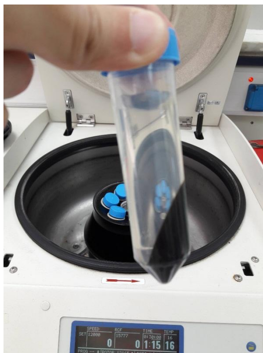
Εικόνα 3.8. Εικόνα falcon ύστερα από φυγοκέντρηση για το διαχωρισμό του στερεού από το υπερκείμενο διάλυμα.
