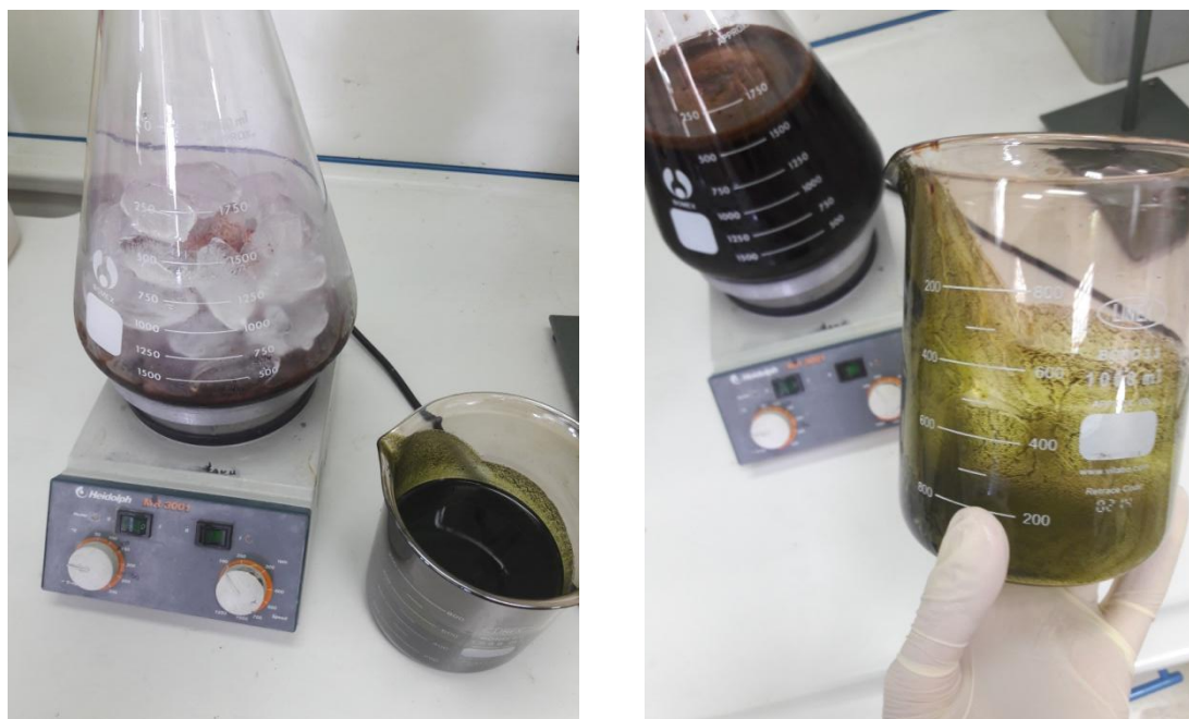
Εικόνα 3.4 Προσθήκη του μίγματος της αντίδρασης σε παγάκια υπερκάθολου νερού.
