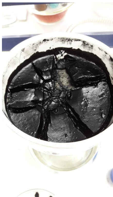
Εικόνα 3.20: Διήθηση υπό κενό σε χωνί τύπου Büchner του μίγματος της αντίδρασης με χρήση διηθητικού χαρτιού για την παραλαβή του αναγμένου οξειδίου του γραφενίου (RGO).
