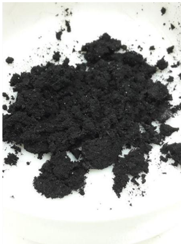
Εικόνα 3.17: Το αναγμένο οξείδιο του γραφενίου μετά το freeze drying.
