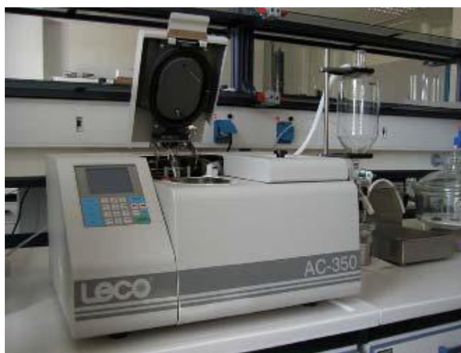
Εικόνα 12: Θερμιδόμετρο AC-350 της LECO, Εργαστήριο Διαχείρισης Τοξικών και Επικινδύνων Αποβλήτων.
