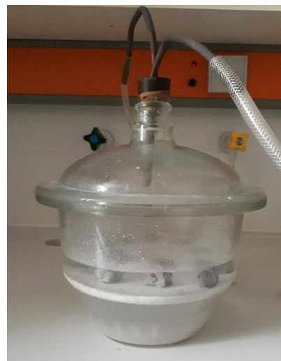
Εικόνα 24: Δοχείο για την μέτρηση του πορώδους, της πυκνότητας και της υδατοαπορροφητικότητάς.
