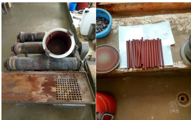
Σχήμα 2.2 : Εργαστηριακός ραβδόμυλος
