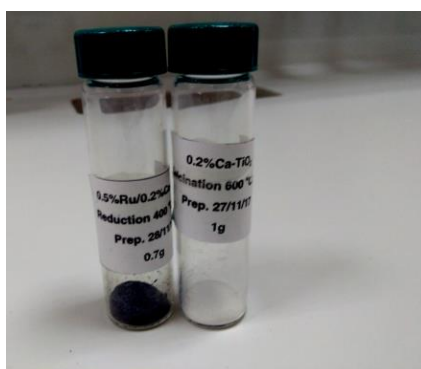
Εικόνα 4.1: Καταλύτης και φορέας σε μορφή σκόνης, οι οποίοι παρασκευάστηκαν στο εργαστήριο Περιβαλλοντικής Κατάλυσης και χρησιμοποιήθηκαν για τη μελέτη της υδρογόνωσης του \text{CO}_2 .
