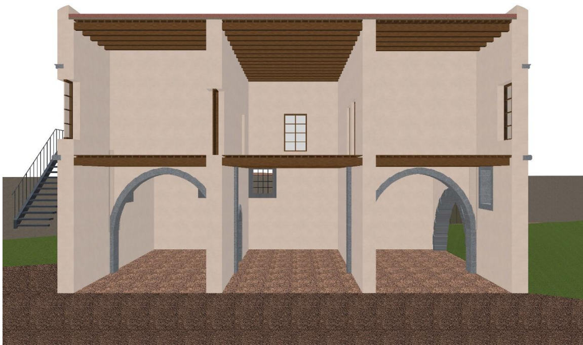
Εικ. 111.Ενδεικτική πρόταση αποκατάστασης – τομή Α-Α
