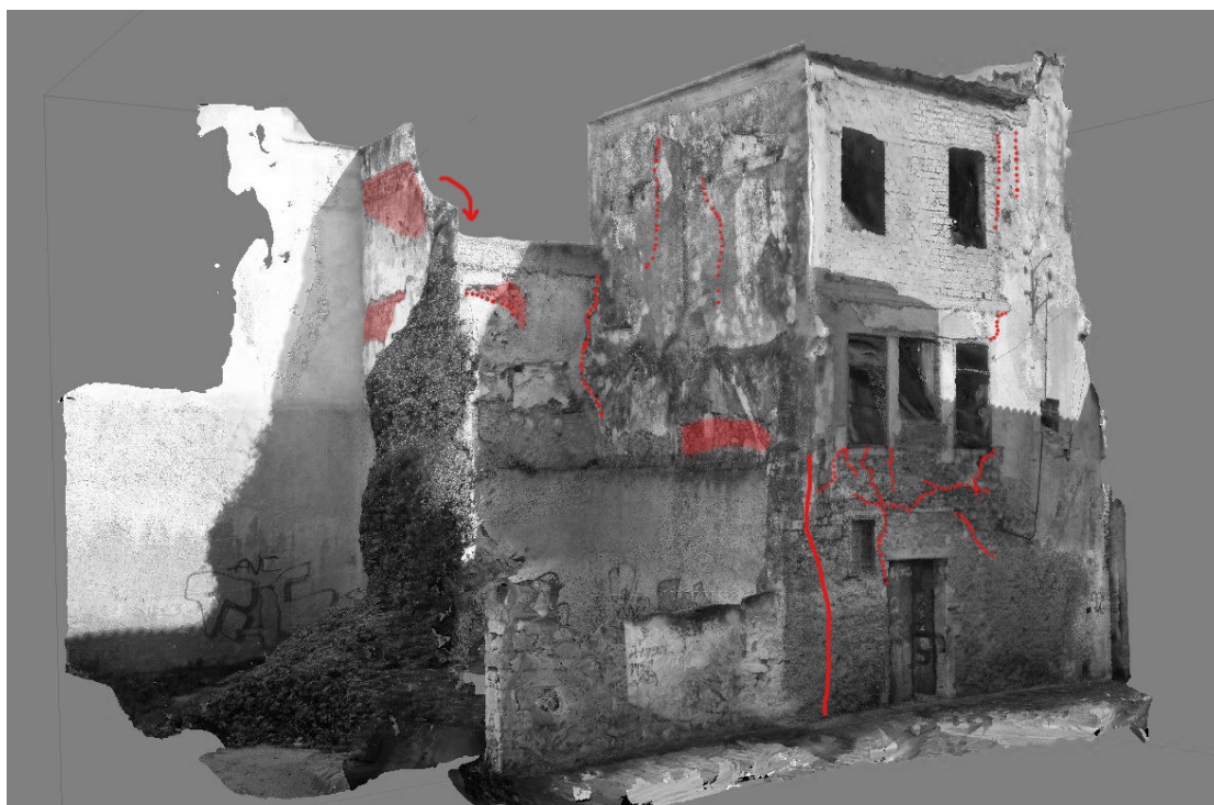
Π 2. Παθολογία Νοτιοδυτικής όψης, με κόκκινο εστιγμένο σημειώνονται οι ρωγμές, με κόκκινη επιφάνεια η πτώση κονιαμάτων, με συνεχή γραμμή η απόκλιση από την κατακόρυφο.
