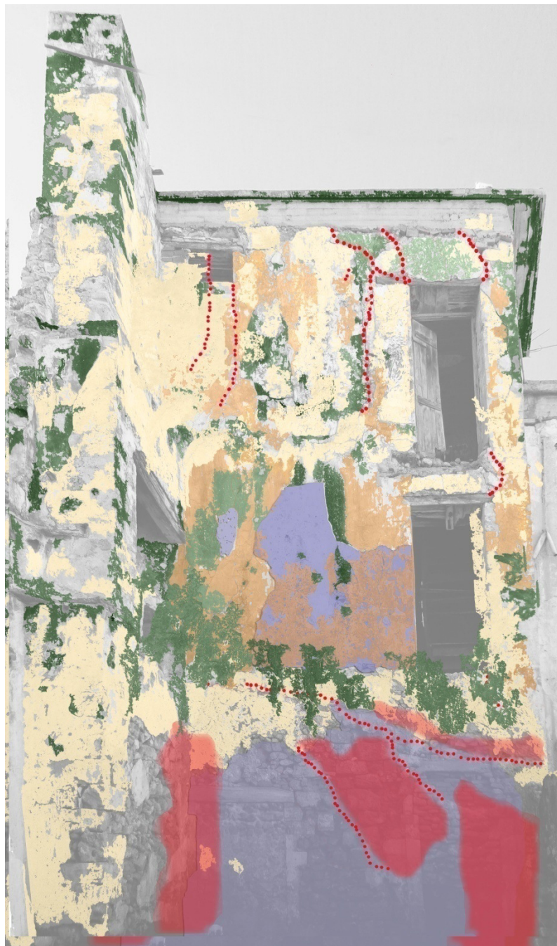
Ε 1. .Ανατολική όψη, τμήμα 1, σχεδιάγραμμα φθορών
