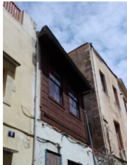
Εικόνα 24. Αριστερά Μπαγδατί επιχρισμένο, δεξιά μπαγδατί με ξύλινο πέτσωμα, Παλαιά πόλη Χανίων
