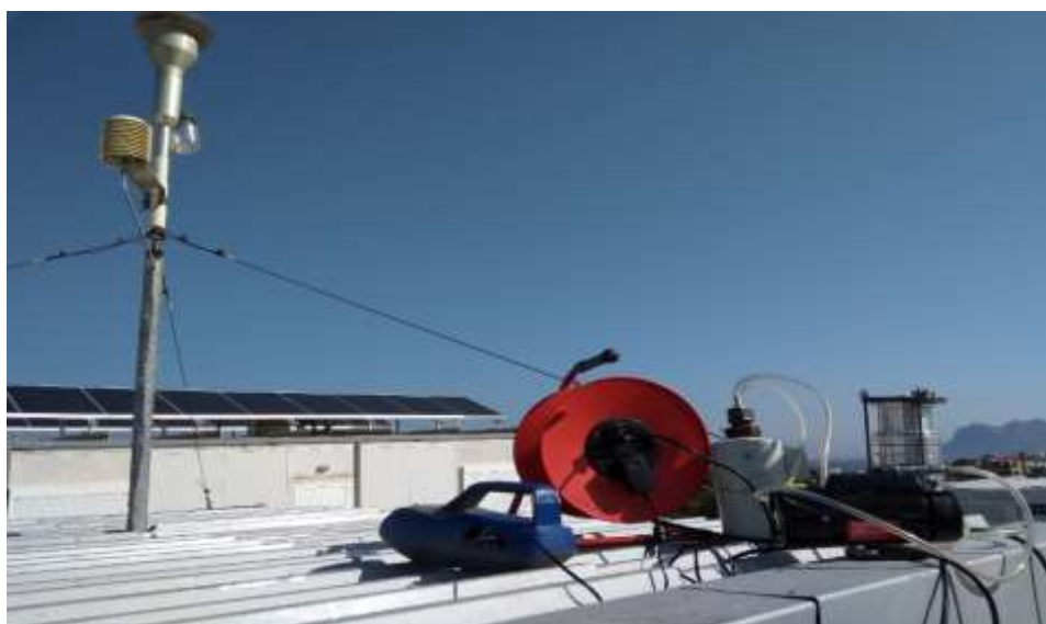
Εικόνα 15: Τα όργανα του πειράματος τοποθετημένα στην οροφή του σταθμού μετρήσεων κατά τη διάρκεια της δειγματοληψίας.
