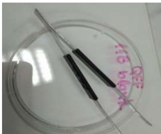
Εικόνα 18: Καθαρό φίλτρο QFF μέσα σε τριβλίο και λαβίδα με το οποίο γίνεται η μεταφορά του.
