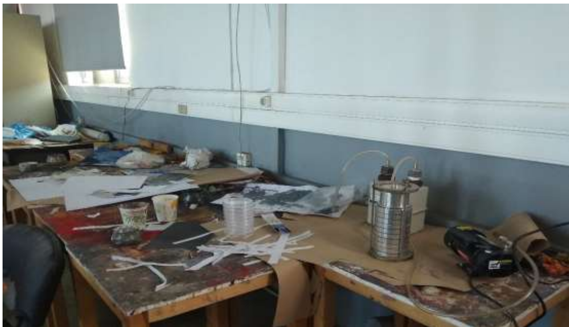
Εικόνα 12: Ο προσκρουστήρας Andersen κατά τη διάρκεια μέτρησης στην αίθουσα ζωγραφικής και σχεδίου.
