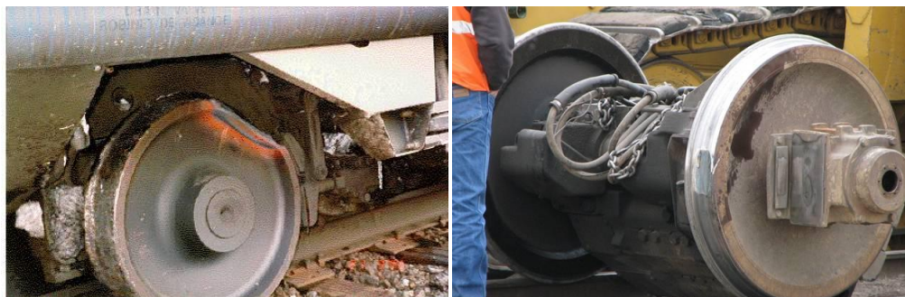
Εικόνα 2.17: Επιπεδώσεις στην κυκλική περιφέρεια των τροχών λόγω της πέδησης/επιβράδυνσης του τρένου ( http://cs.trains.com/trn/f/111/t/251253.aspx , http://www.trainboard.com/highball/index.php?threads/simple-project-gone-wrong.52720/ , 2018).
