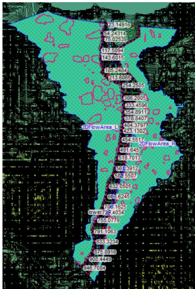
Εικόνα 4.5.4.9: Σχεδιασμός πλευρικών δομών (lateral structures) σύνδεσης 1D ροής του ρέματος με τις 2D επιφάνειες ροής (HEC-RAS 5.0.3).
