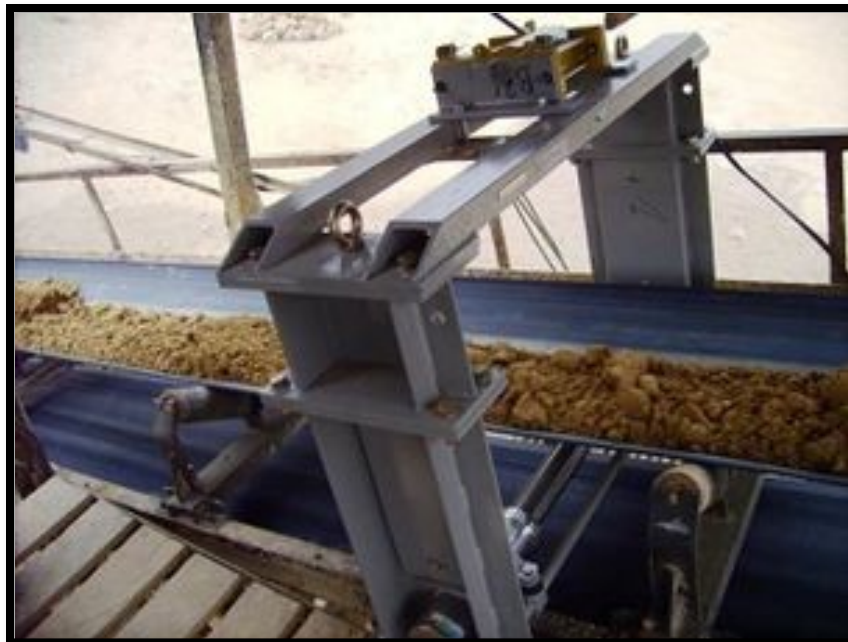
Σχήμα 1.5: Σύστημα προσδιορισμού παροχής και υγρασίας με χρήση αισθητήρα μικροκυμάτων, τύπου LB 472 ( https://www.berthold.com/ )
