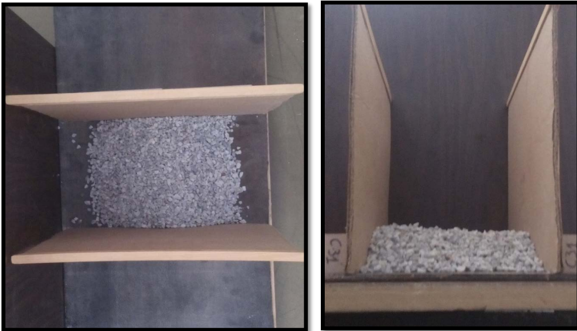
Σχήμα 4.7: Εξάπλωση υλικού επί του ιμάντα σε κάτοψη (αριστερά) και πλάγια όψη (δεξιά). Τα κάθετα τοποθετημένα επί του ταινιοδρόμου ξύλινα φύλλα λειτουργούν ως οδηγοί που σηματοδοτούν την έναρξη και λήξη των μετρήσεων με τον σαρωτή LIDAR.
