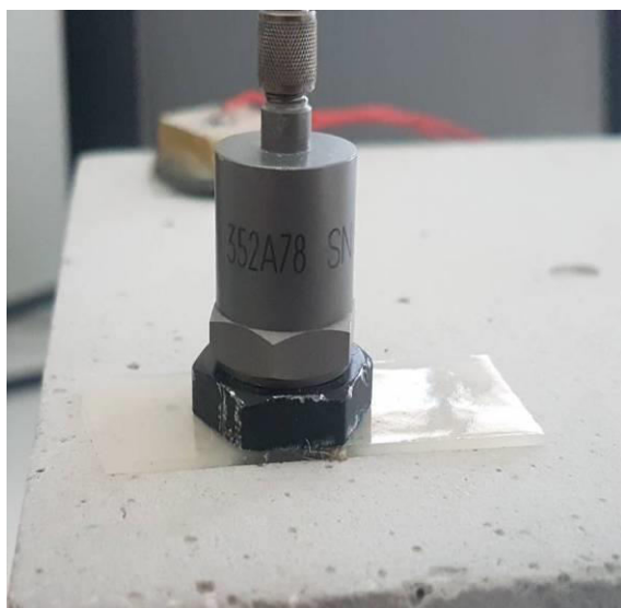
Εικόνα 2.5 Πιεζοηλεκτρικός αισθητήρας
