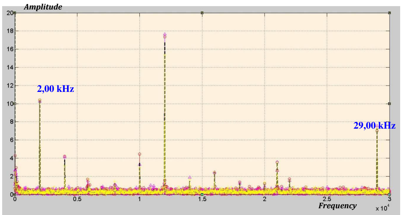
Εικόνα 4.20 Πεδίο του φάσματος στην περίπτωση των τριών μετρήσεων των δονητικό ακουστικών δοκιμών, του κύματος μεγέθυνσης των 2,00kHz και του κύματος διεισδυτικής ανίχνευσης των 29,00 kHz
