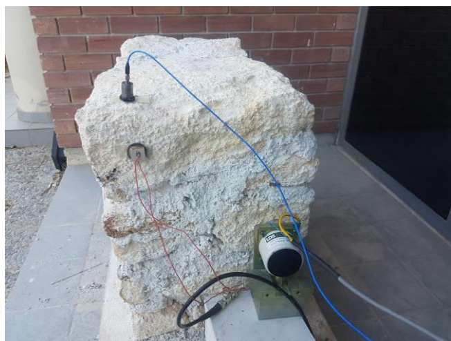
Εικόνα 5.27 Διάταξη εξοπλισμού για τον έλεγχο της μη γραμμικής συμπεριφοράς του δοκιμίου
