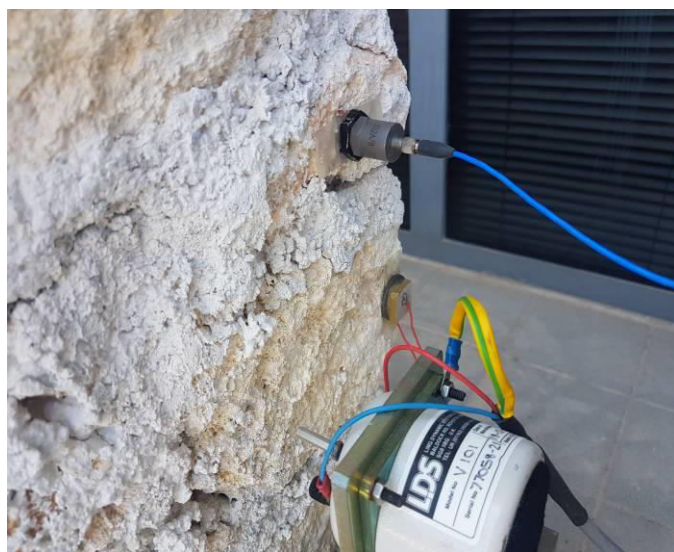
Εικόνα 5.37 Διάταξη εξοπλισμού για τον έλεγχο της γραμμικής συμπεριφοράς του δοκιμίου
