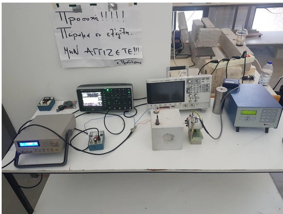
Εικόνα 5.1 Διάταξη εξοπλισμού πειραματικού έλεγχου για την αξιολόγηση του δομικού υλικού
