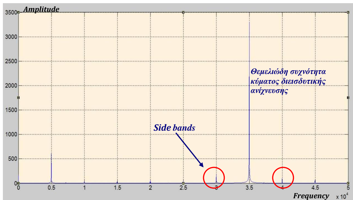
Εικόνα 5.8 Πεδίο του φάσματος των συχνοτήτων στην περίπτωση του κύματος μεγέθυνσης των 7,20 kHz και κύματος διεισδυτικής ανίχνευσης των 65,00 kHz
