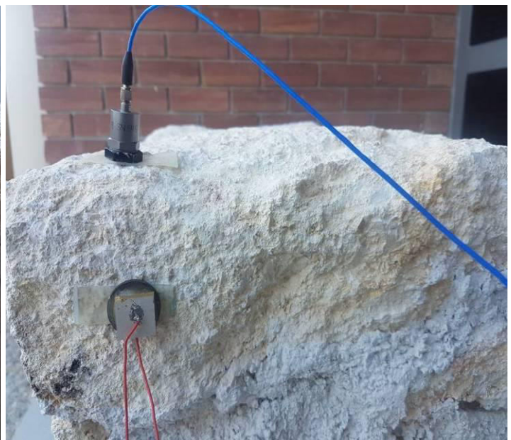
Εικόνα 5.23 θέσεις τοποθέτησης εξοπλισμού διεγερτών και καταγραφέα για τον έλεγχο της μη γραμμικής συμπεριφοράς του δοκιμίου
