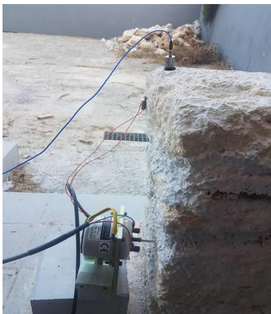
Εικόνα 5.23 θέσεις τοποθέτησης εξοπλισμού διεγερτών και καταγραφέα για τον έλεγχο της μη γραμμικής συμπεριφοράς του δοκιμίου
