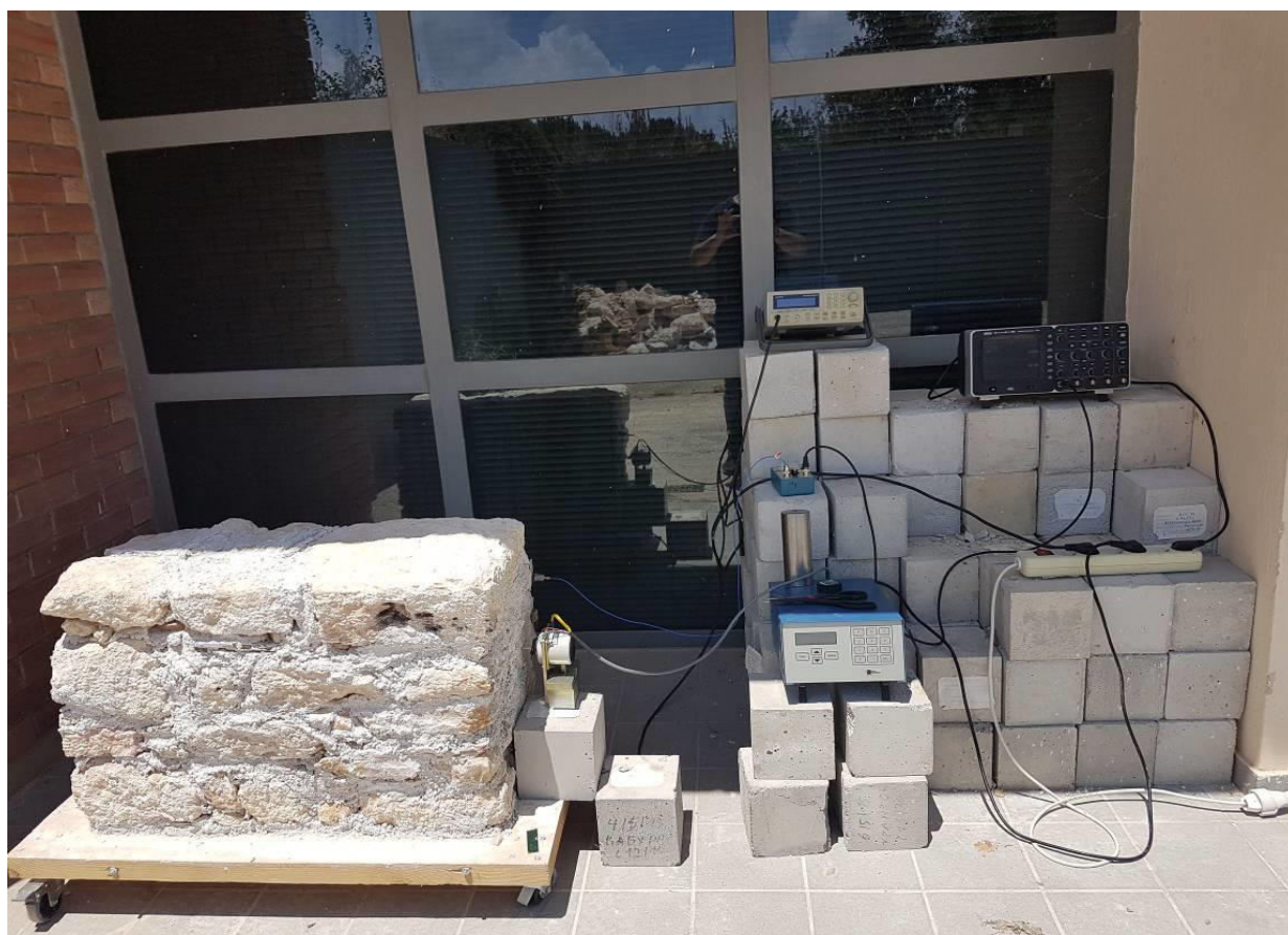
Εικόνα 5.25 Διάταξη πειραματικού εξοπλισμού για αξιολόγηση δομικής ακεραιότητας δοκιμίου από λιθοδομή
