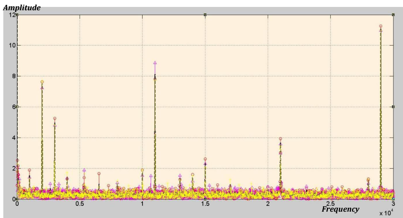
Εικόνα 4.36 Πεδίο του φάσματος στην περίπτωση των τριών μετρήσεων, μετά την μεταβολή της δυσκαμψίας, για διέγερση μεγέθυνσης των 2,00kHz και του κύματος διεισδυτικής ανίχνευσης των 29,00 kHz
