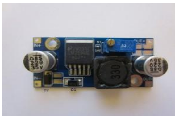
Σχήμα 5.7. Module LM2596.
