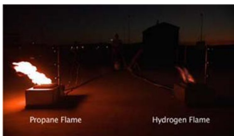
Σχήμα 1. 3: Φλόγα προπανίου και φλόγα υδρογόνου κατά την καύση σε ώρα που επικρατεί σκοτάδι [23]
