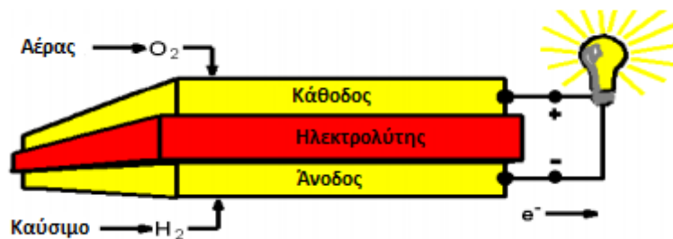
Σχήμα 1. 10: Μέρη κυψελίδας καυσίμου [28]
