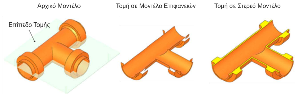
Σχήμα 5.3: Τομή σε ένα Μοντέλο Επιφανειών και σε ένα Στερεό Μοντέλο
