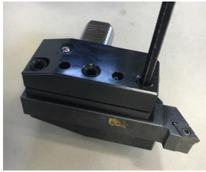
Σχήμα 3.3 Διάταξη ενός εργαλείου-εργαλειοφορέας(δεξιά)
