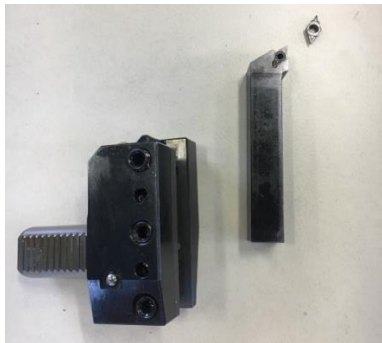
Σχήμα 3.3 Διάταξη ενός εργαλείου-εργαλειοφορέας(δεξιά)
