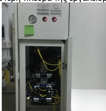
Σχήμα 3.6: Ρυθμιστές υδραυλικής πίεσης
