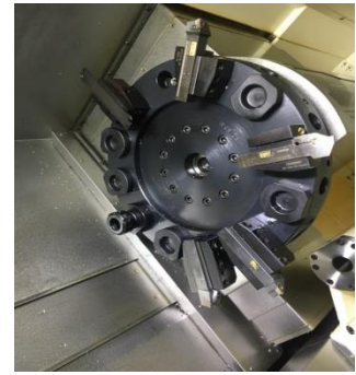
Σχήμα 3.3 Διάταξη ενός εργαλείου-εργαλειοφορέας(δεξιά)
