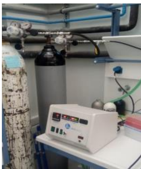
Εικόνα 23: Η συσκευή ελέγχου του αντιδραστήρα και οι φιάλες παροχής αέρα
