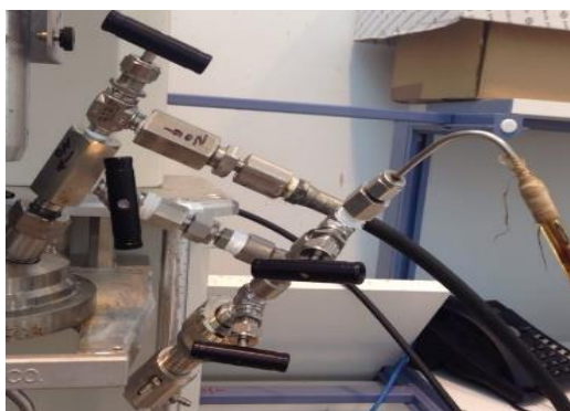
Εικόνα 20: Επέκταση διάταξης βαλβίδων
