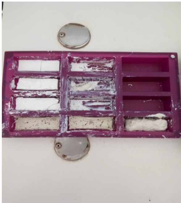
Σχήμα 2.3.: Ξήρανση των δοκιμίων.
