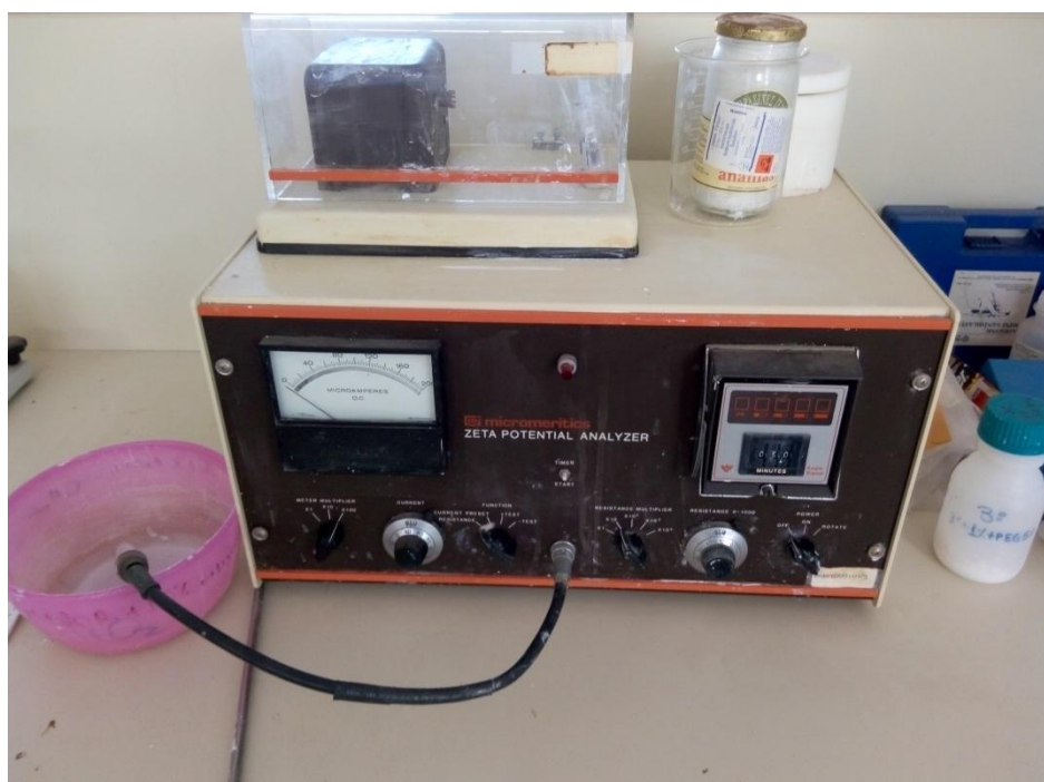
Σχήμα 3.11.: Αναλυτής Z- Δυναμικού.
