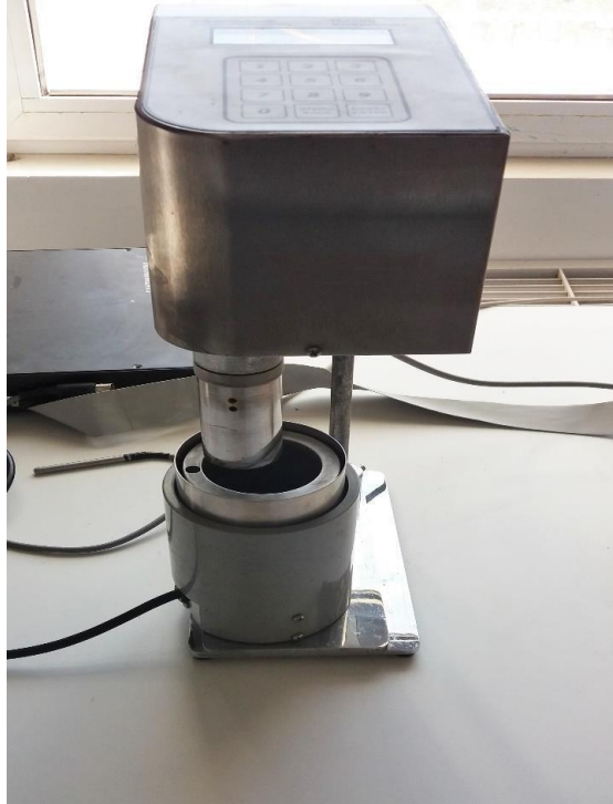
Σχήμα 3.10.: Ιξωδόμετρο Grace Instrument M3500a[16].
