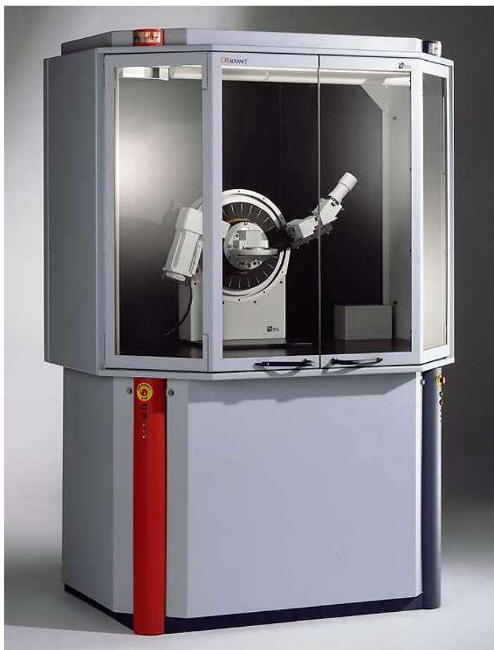
Σχήμα 3.14.: Συσκευή D8 Advance[19].
