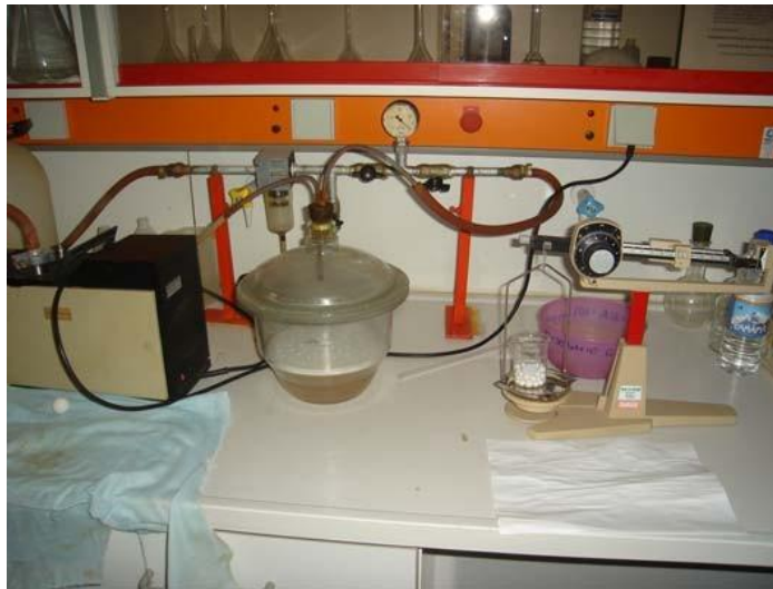
Σχήμα 3.15.: Πειραματική διάταξη της μεθόδου DIN EN 993-1.
