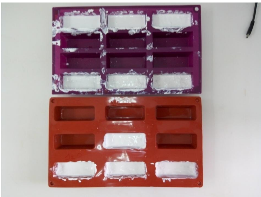
Σχήμα 2.2.: Μορφοποίηση μείγματος σε καλούπια σιλικόνης.
