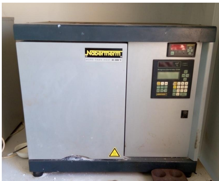
Σχήμα 3.8.: Φούρνος έψησης δοκιμίων.
