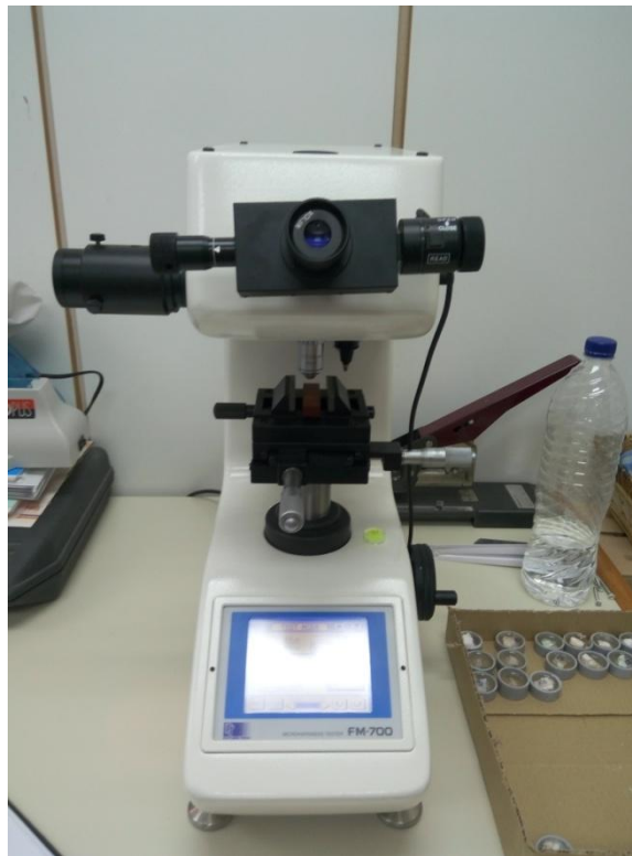
Σχήμα 3.17.: Μηχάνημα Microhardness tester fm-700.
