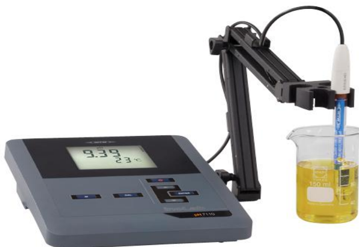
Σχήμα 3.9.: Μηχάνημα μέτρησης pH και θερμοκρασίας[15].
