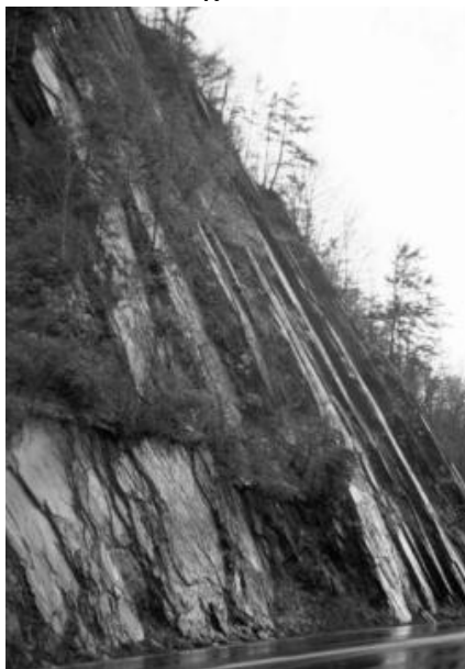
Σχήμα 3. 2: Μηχανισμός αστοχίας με επίπεδη ολίσθηση. (Shale on route 19 near Robbinsville, North Carolina, Wyllie, 2004)
