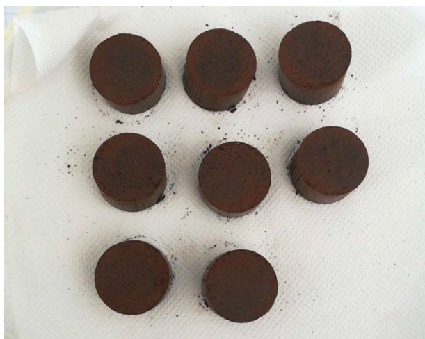
Εικόνα 14: Μορφοποιημένα κυλινδρικά δοκίμια E.I.
