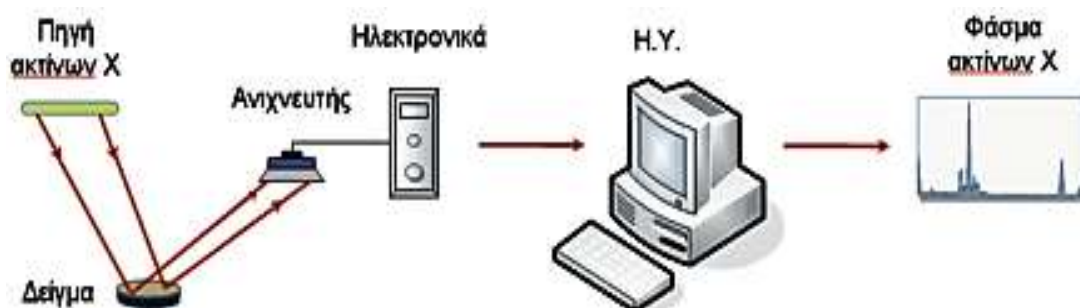
Εικόνα 7 :Τυπική διάταξη XRF ( www.omega.physics.uoi.gr )
