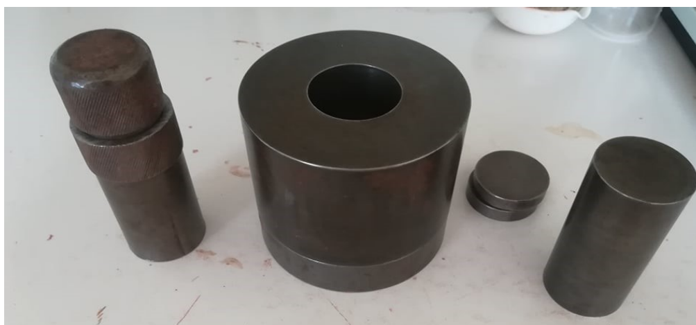
Εικόνα 18: Μεταλλικά καλούπια μορφοποίησης υλικού.
