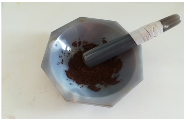
Εικόνα 12: Δείγματα E.I. κονιοποιημένο με γουδί από αχάτη.
