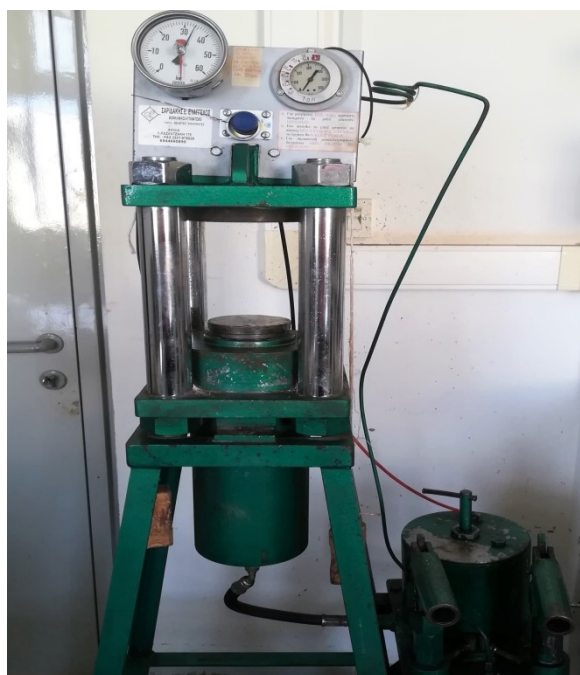
Εικόνα 13 : Υδραυλική πρέσα συμπίεσης.
