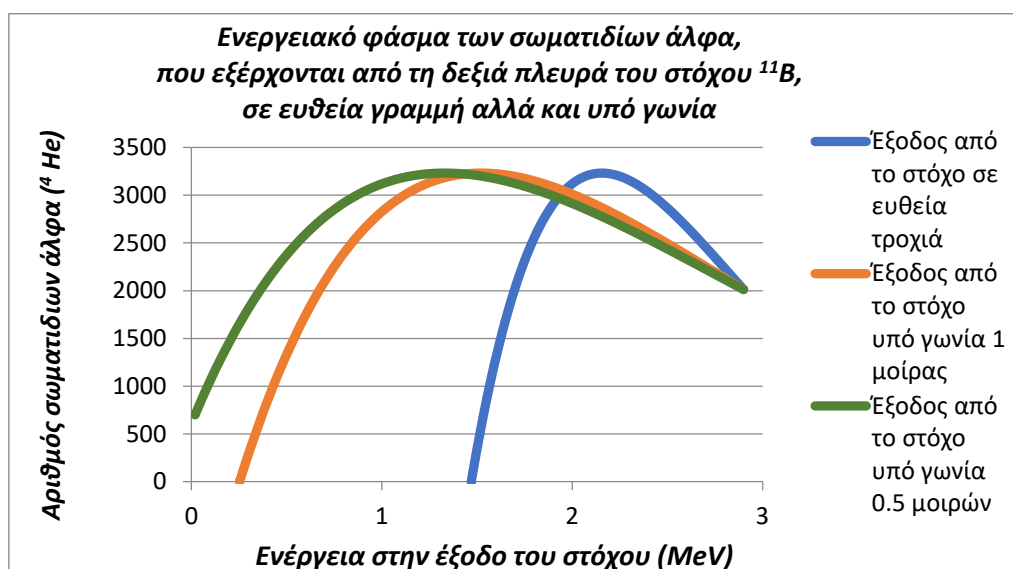
Σχήμα 4.17 : Ενεργειακό φάσμα των σωματιδίων άλφα, που εξέρχονται από τη δεξιά πλευρά του στόχου {}^{11}_5\text{B} , για τη δέσμη πρωτονίων με E_K(0) = 0.4\text{ MeV} .
