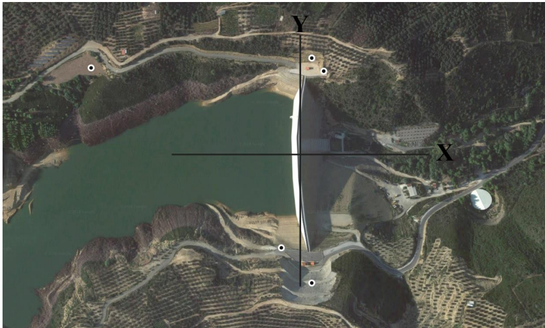
Σχήμα 8.1:Προτεινόμενη γεωμετρία βάθρων για την παρακολούθηση του φράγματος Βαλσαμιώτη.
