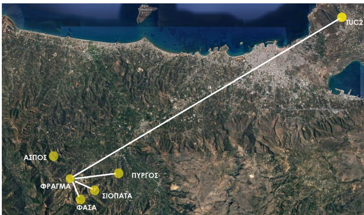
Σχήμα 7.19: Επίλυση του φράγματος από κάθε σημείο στο HTRS-07
