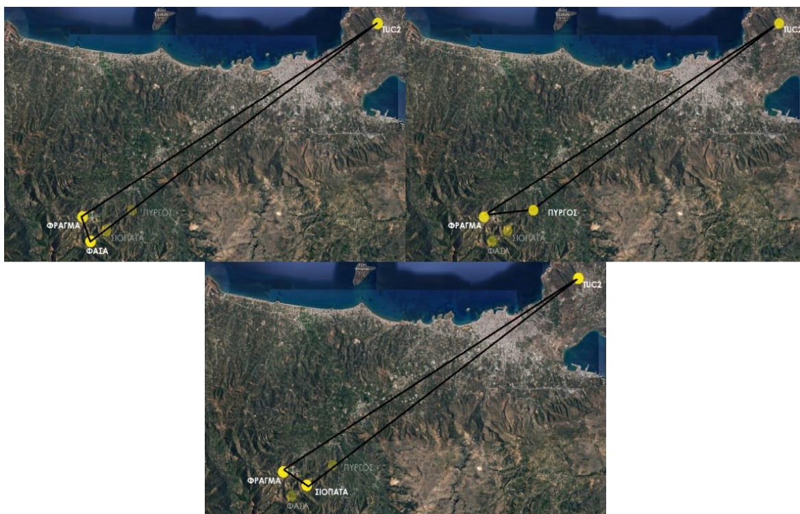
Σχήμα 7.15: Επίλυση τριγωνομετρικών δικτύων στο ΕΓΣΑ-87.
