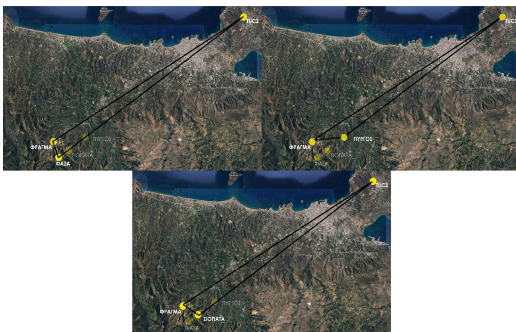
Σχήμα 7.18: Επίλυση τριγωνομετρικών δικτύων στο WGS-84.
