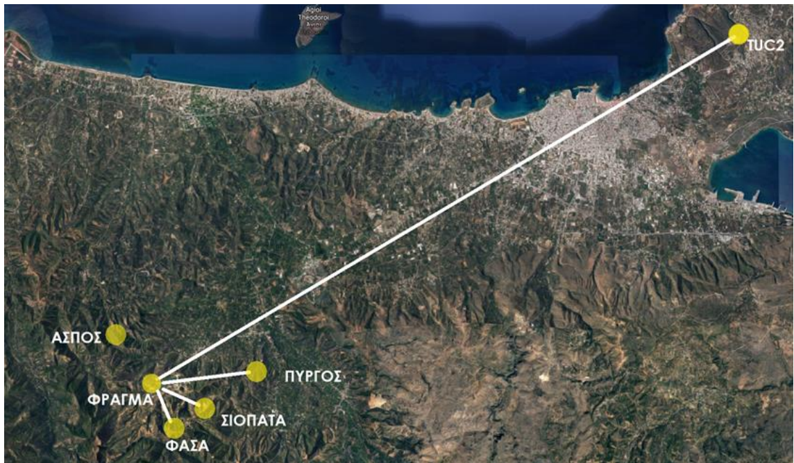
Σχήμα 7.10: Επίλυση του φράγματος ξεχωριστά από κάθε σημείο του γεωδαιτικού δικτύου.
