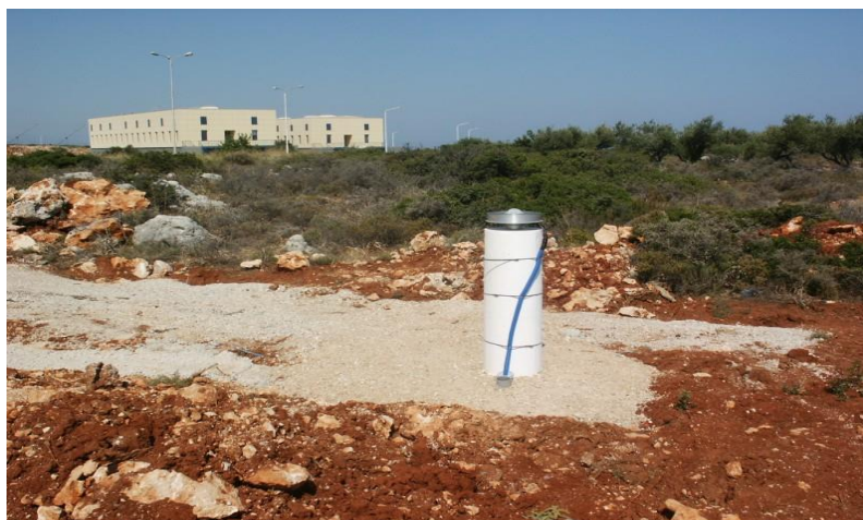
Σχήμα 6.3: Μόνιμος σταθμός GPS (TUC2)
