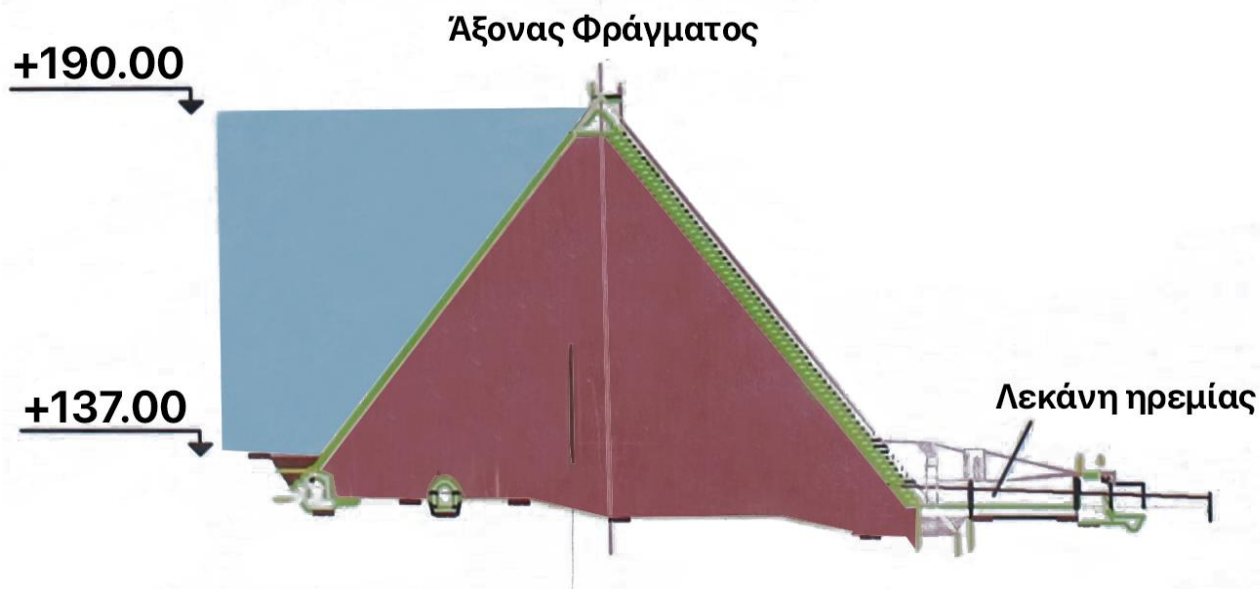
Σχήμα 3.3: Τυπική διατομή φράγματος στη θέση του υπερχειλιστή.
