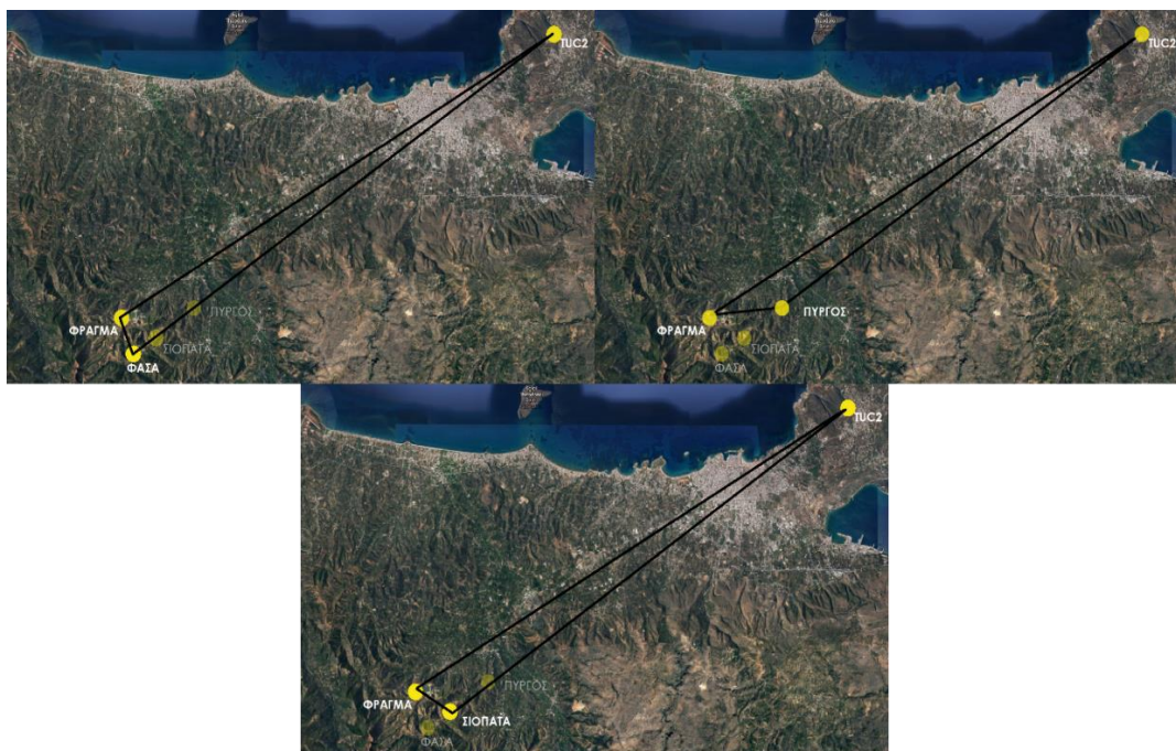
Σχήμα 7.20: Επίλυση τριγωνομετρικών δικτύων στο HTRS-07
