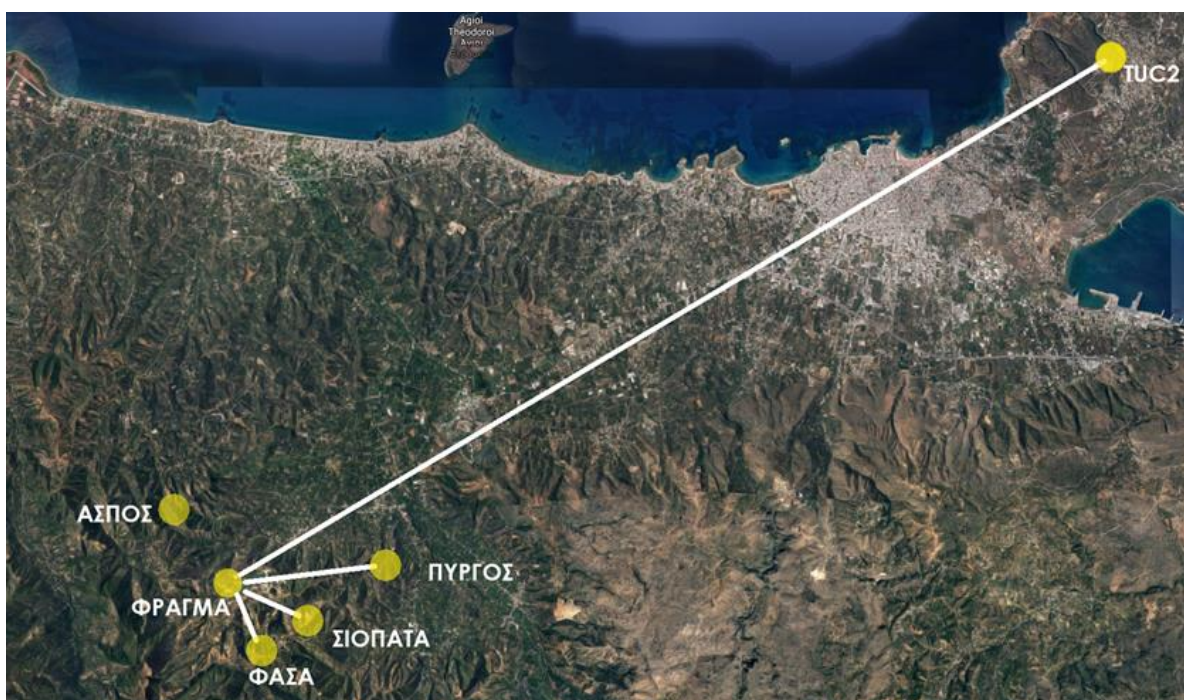
Σχήμα 7.17: Επίλυση του φράγματος από κάθε σημείο στο WGS-84
