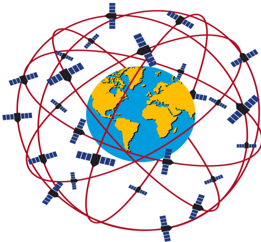
Σχήμα 5.1: Οι τροχιές των δορυφόρων GPS
