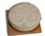
Φυσική Υδραυλική Άσβεστος - NHL διαστολή δοκιμίου \approx 10\%
