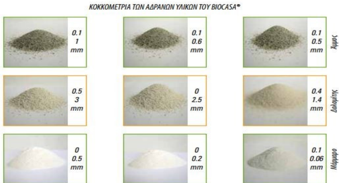
Εικόνα 1.7: Κοκκομετρία των αδρανών υλικών του BIOCASA
