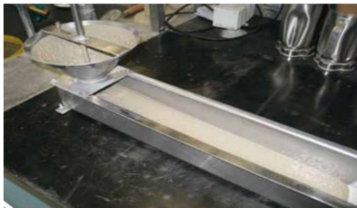
Εικόνα 2.14 : Κανάλι ροής για δοκιμές ενέματος
