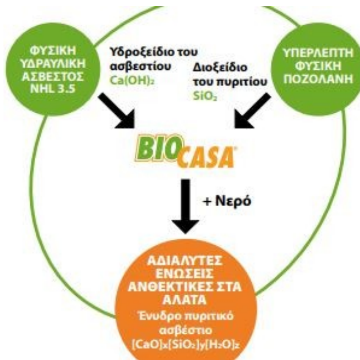
Εικόνα 1.8 : Σύσταση προϊόντος BIOCASA με την προσθήκη ποζολανής
