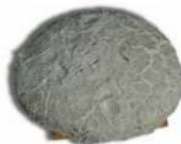
Τσιμέντο Portland διαστολή δοκιμίου \approx 40\%
