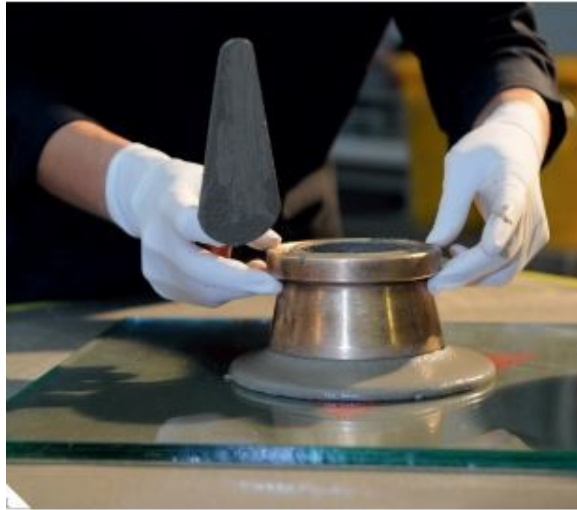
Εικόνα 2.9 : Δοκιμή ροής με κώνο Hägermann
