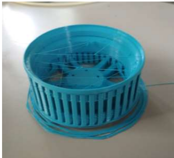
Εικόνα 54: κατακόρυφα στηρίγματα και βάση brim
