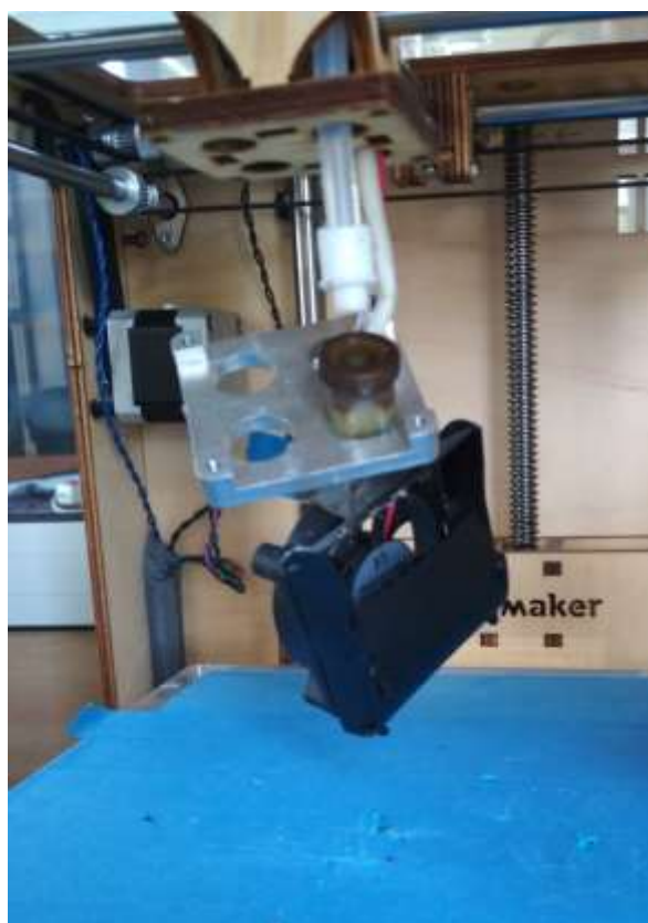
Εικόνα 66: λύσιμο και καθαρισμός κεφαλής
