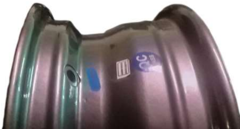
Εικόνα 28: άποψη προφίλ για ζάντα για όχημα 4x4
