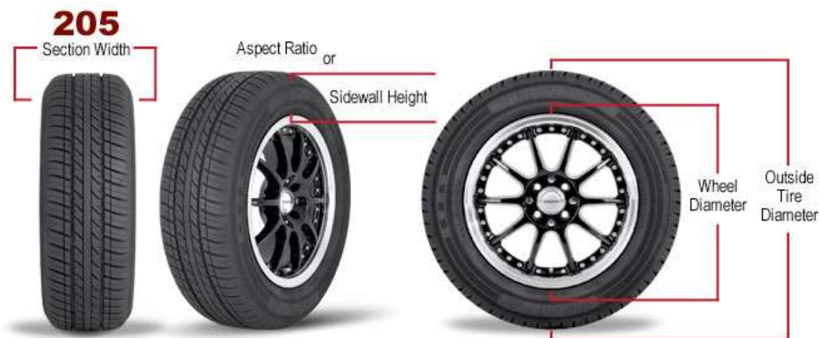
Εικόνα 18: προφίλ ελαστικού , πλάτος ελαστικού
