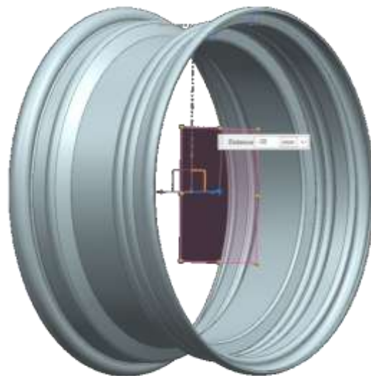
Εικόνα 32: σώμα εκ περιστροφής και ορισμός επιπέδου mounting hub
