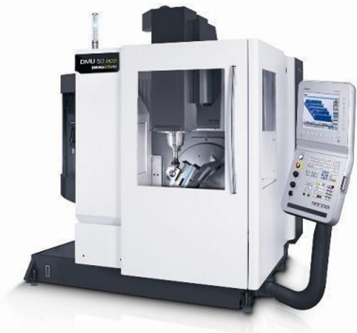
Σχήμα 3.5: Κέντρο κατεργασίας Deckel Maho DMU 50 eco
