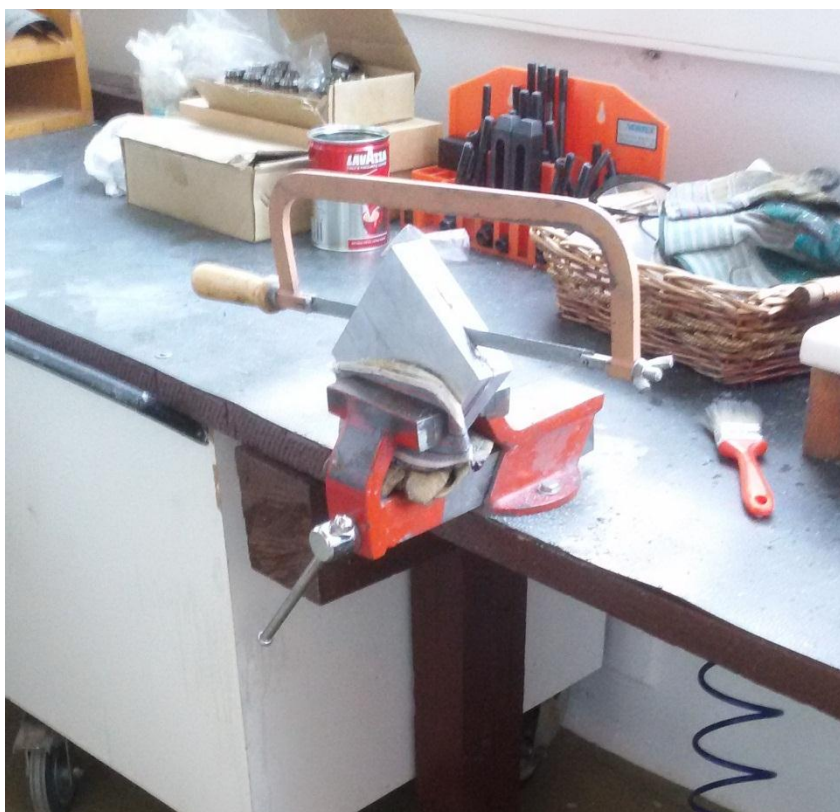
Σχήμα 6.11.4 Χειροκίνητη κοπή με σιδηροπρίονο της εναπομείνουσας πλάκας
