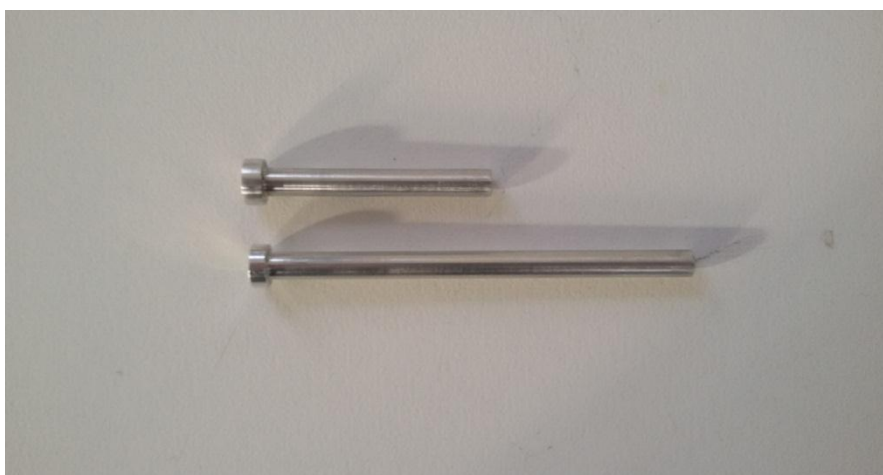
Σχήμα 6.11.20 Κατεργασμένος πείρος πυρήνα και εξολκέας
