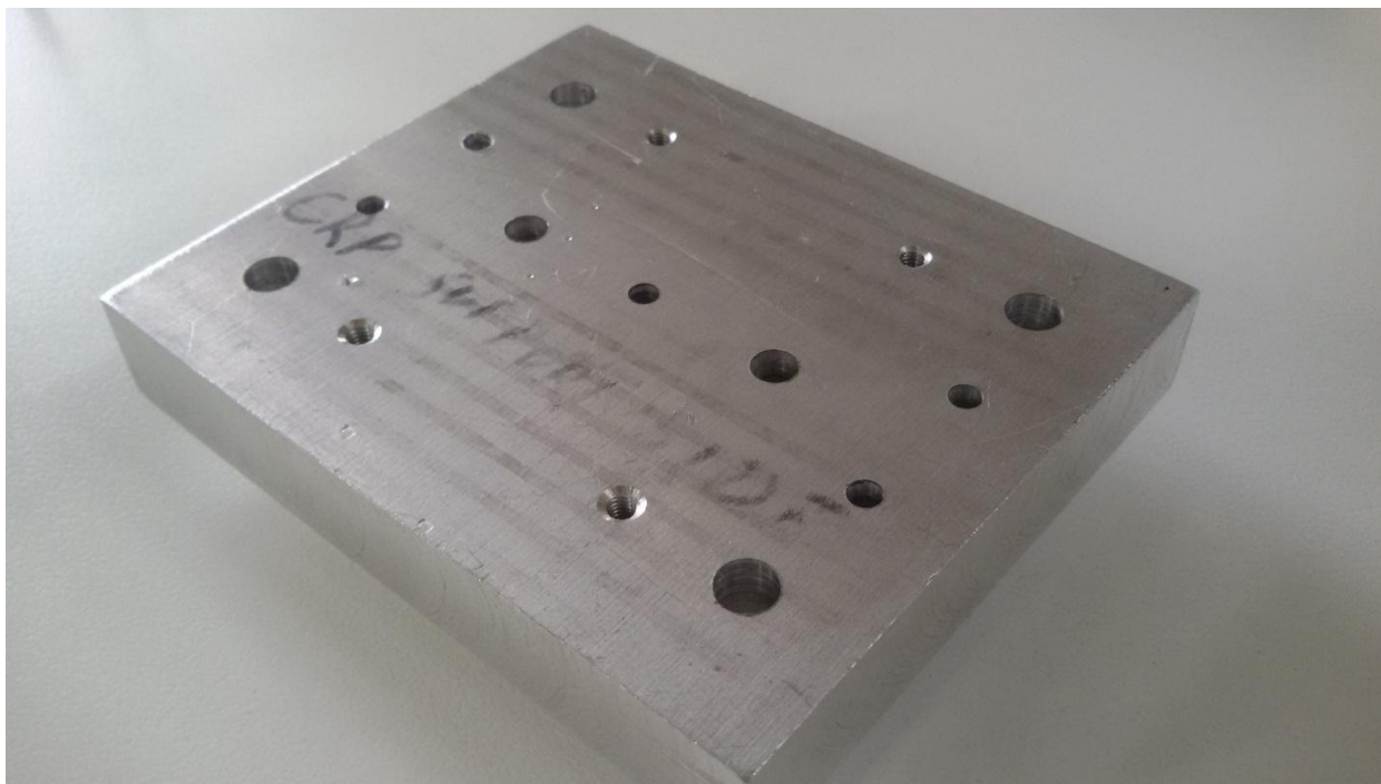
Σχήμα 6.11.15 Κατεργασμένη πλάκα πυρήνων με σπειροτομημένες οπές, πλευρά πλευρά πλακών υποστήριξης
