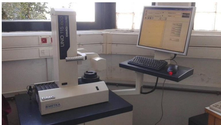
Σχήμα 4.3 Συσσκευή προρύθμισης εργαλείων MICROSET Uno 115 eco
