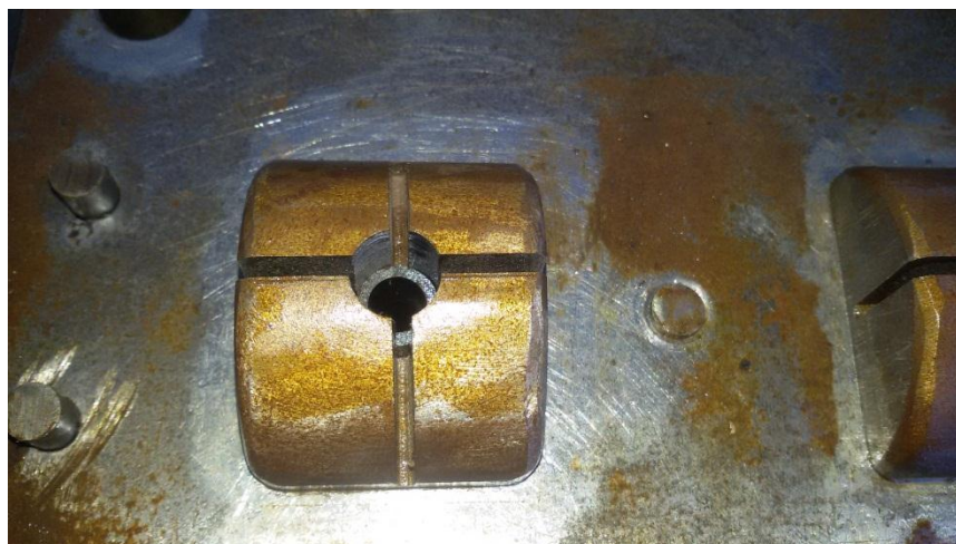
Σχήμα 3.1.3 Ένθετος πυρήνας και εξολκείς
