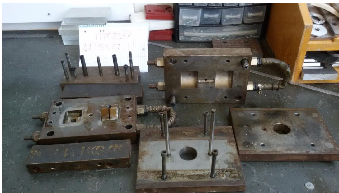
Σχήμα 3.1.8 Αποσυναρμολογημένο καλούπι
