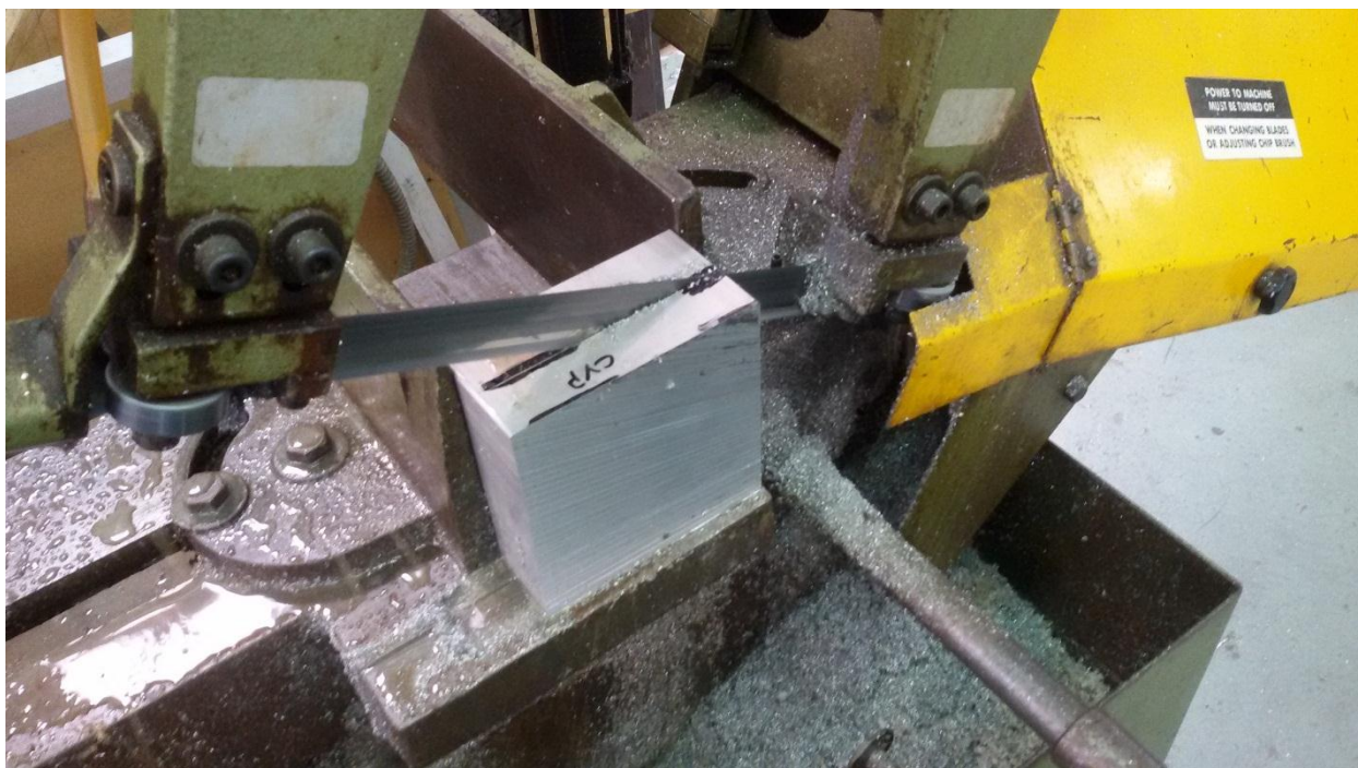
Σχήμα 6.11.3 Κοπή πλακών στο πριόνι κορδέλας
