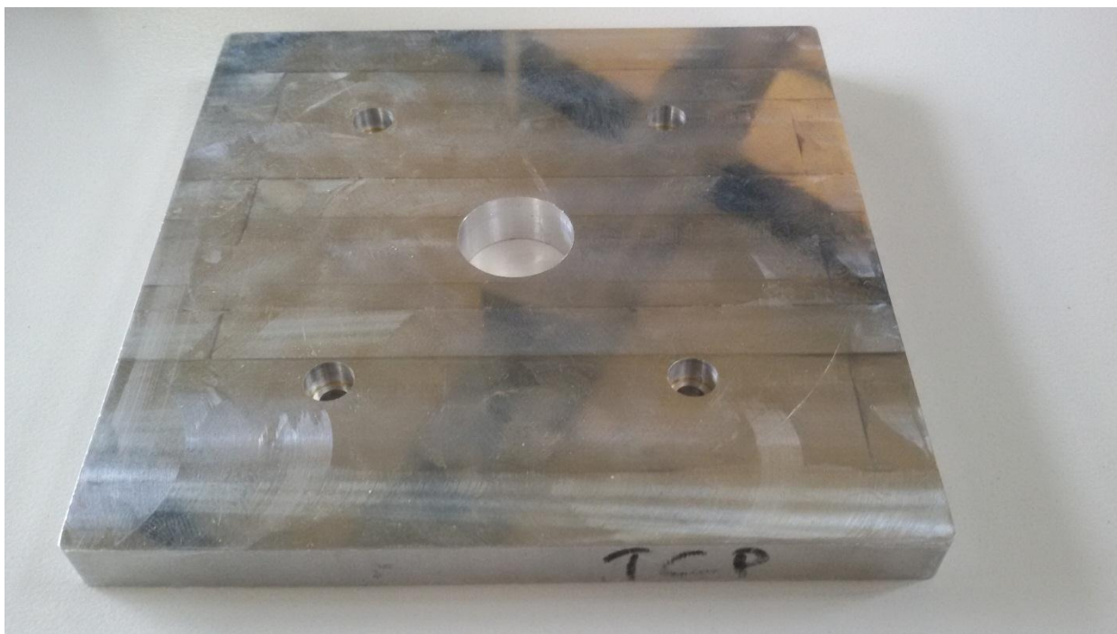
Σχήμα 6.11.9 Κατεργασμένη άνω πλάκα συγκράτησης
