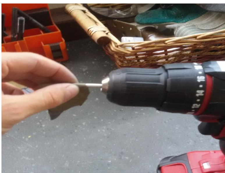
Σχήμα 6.11.21 Επεξεργασία μετά από τις κατεργασίες για επίτευξη ανοχών συναρμογής
