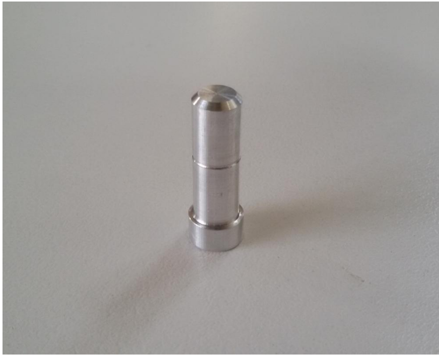
Σχήμα 6.11.22 Κατεργασμένος οδηγός πείρος
