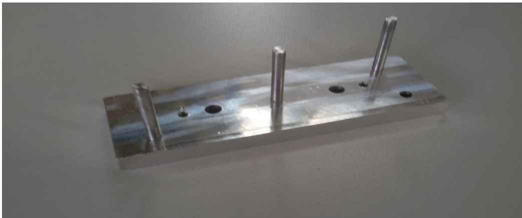
Σχήμα 6.11.24 Συναρμολόγηση εξολκίων πείρων με την την πλάκα εξολκίων Α
