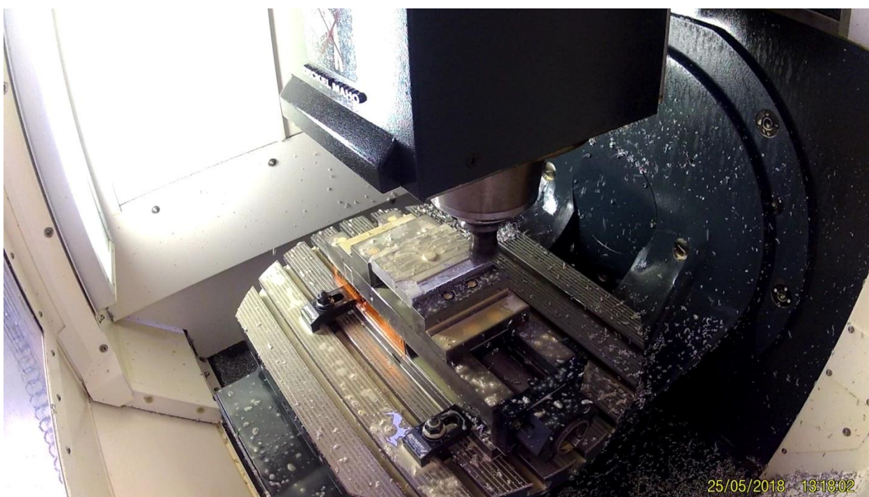
Σχήμα 6.11.8 Κατεργασία φραιζαρίσματος για την δημιουργία της προεξοχής στην πλάκα κοιλοτήτων
