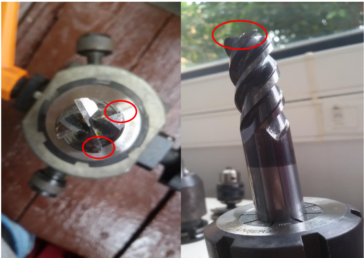
Σχήμα 6.12.3 Σπασμένες ακμές κοπτικού εργαλείου διαμέτρου 16 mm
