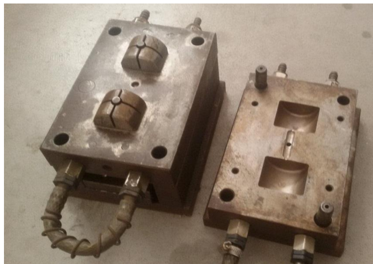
Σχήμα 3.1.2 Το πρωτότυπου καλούπι διαιρεμένο
