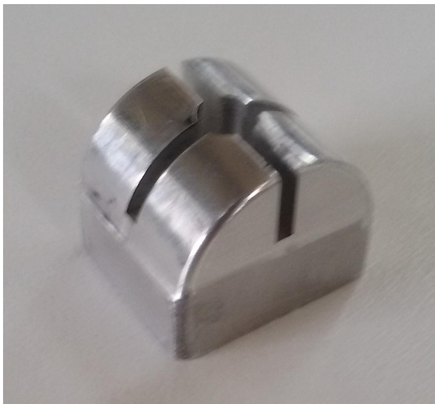
Σχήμα 6.11.13 Κατεργασμένος ένθετος πυρήνας
