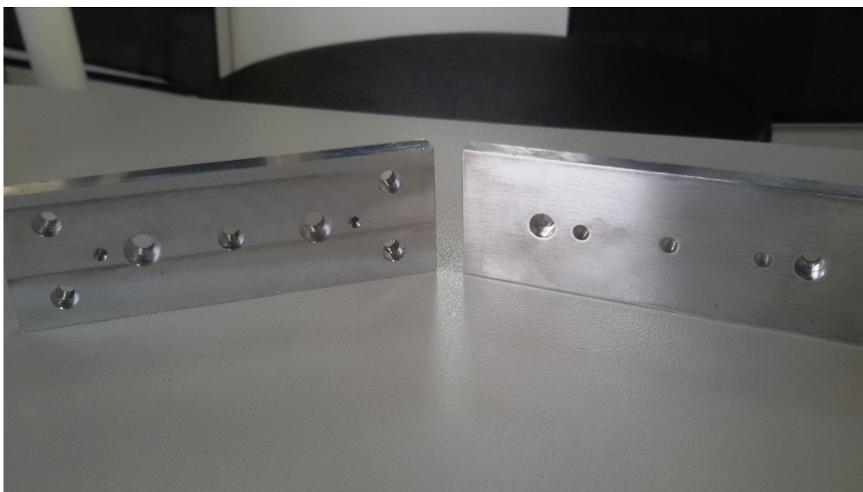
Σχήμα 6.11.16 Κατεργασμένες πλάκες εξολκείων Α και Β
