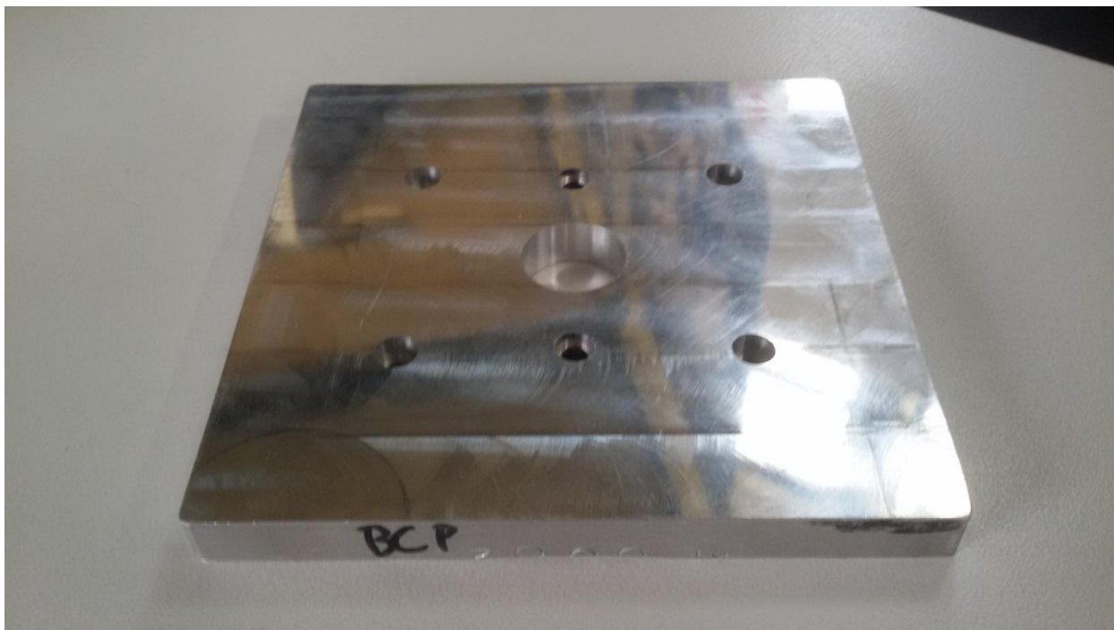
Σχήμα 5.11.17 Κατεργασμένη κάτω πλάκα συγκράτησης
