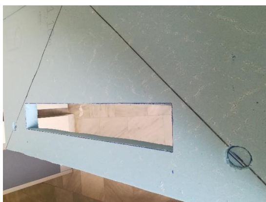
Εικόνα 4.7: Εγκοπή για την εισαγωγή των θερμοηλεκτρικών στοιχείων
