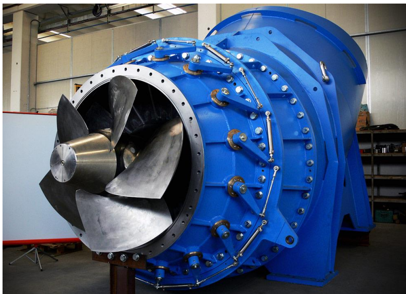
Εικόνα 3. 6 Υδροστρόβιλος Τύπου Kaplan ( zeko.it )
