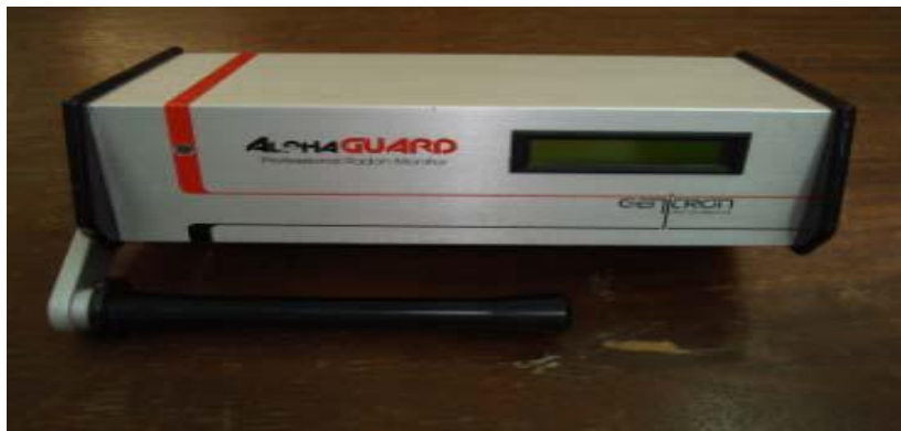
Εικόνα 2.1: Ενεργητικός ανιχνευτής Alpha GUARD (Κασινάλης, 2008).
