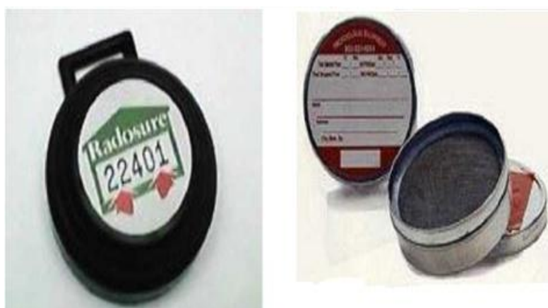
Εικόνα 2.2: Παθητικοί ανιχνευτές καταγραφής ιχνών και ενεργοποιημένου άνθρακα (Ε.Ε.Α.Ε, 2005).
