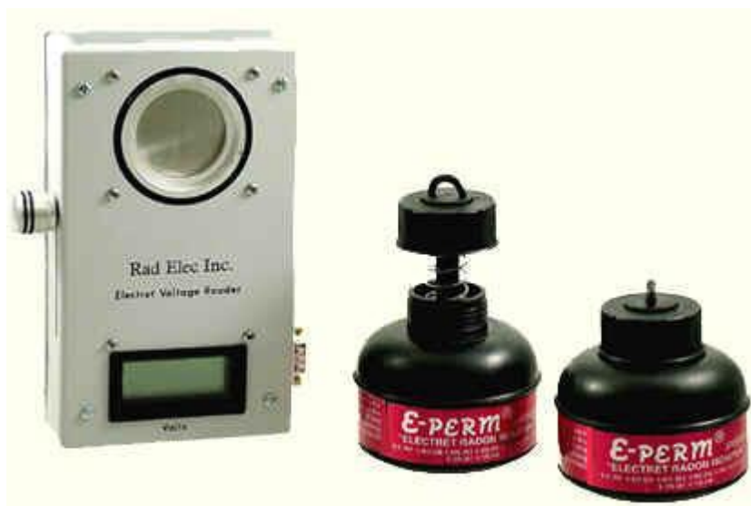
Εικόνα 2.4: Ανιχνευτής Electret (E-PERM) (Κοντάκου, 2011)
