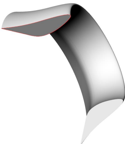
Σχήμα 4.4: Προοπτική προβολή της αρχικής γεωμετρίας του διαχύτη.
