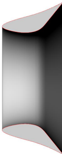
Σχήμα 4.3: Πλάγια όψη (σε τομή) της αρχικής γεωμετρίας του διαχύτη.
