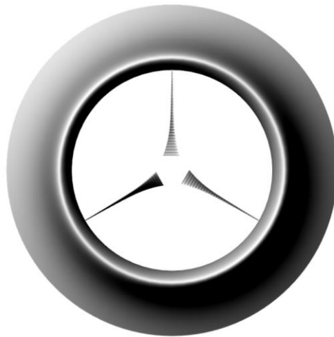
Σχήμα 6.1: 3D απεικόνιση του συστήματος διαχύτη – πτερυγίων που σχεδιάστηκε.
