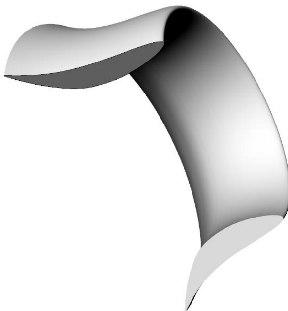
Σχήμα 4.11: Προοπτική προβολή της βελτιστοποιημένης γεωμετρίας του διαχύτη.
