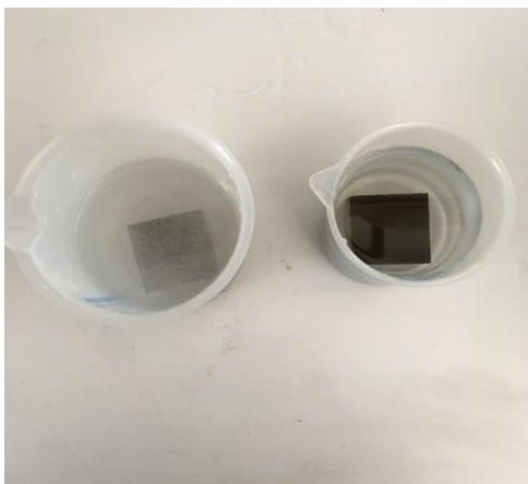
Σχήμα 6.9: Εμβάπτιση δοκιμίων σε θαλασσινό και απιονισμένο νερό
