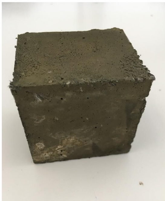
Σχήμα 6.5: Δοκίμιο από σκωρία με ίνες πολυτροπυλενίου έτοιμο προς θραύση
