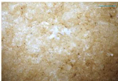
Εικόνες 75 -76: Untreated - Treated δοκίμιο Πεντελικού μαρμάρου με φυσική πάτινα
