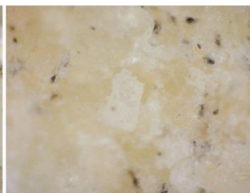
Εικόνες 89 - 90: Untreated - Treated δοκίμιο Πεντελικού μαρμάρου με φυσική πάτινα
