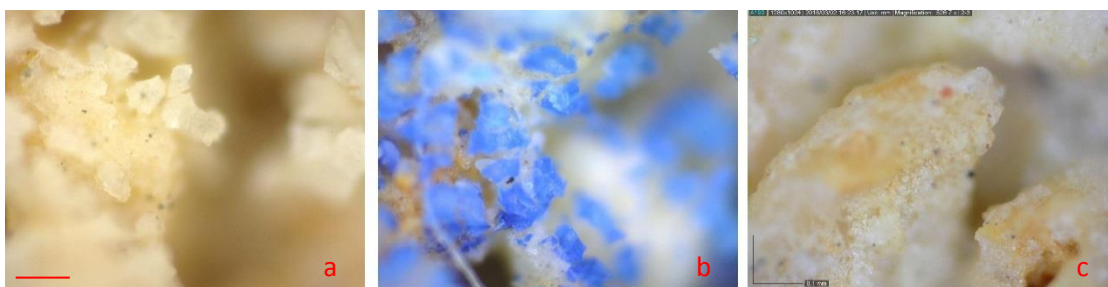
Εικόνες 130 (a - c): Treated δοκίμια PRC πριν την εφαρμογή του MB, αμέσως μετά τον χρωματισμό και μετά την έκθεση στο UV
