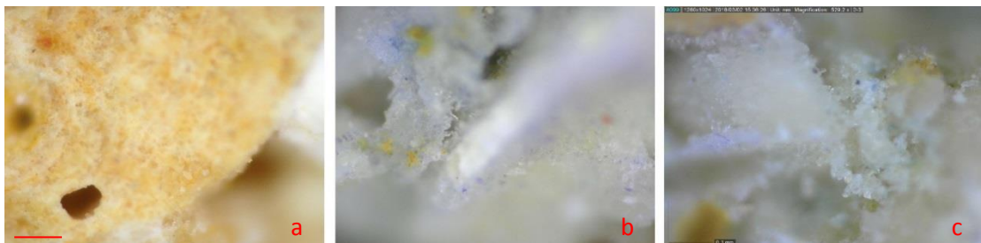
Εικόνες 129 (a - c): Untreated δοκίμια PRC πριν την εφαρμογή του MB, αμέσως μετά τον χρωματισμό και μετά την έκθεση στο UV
