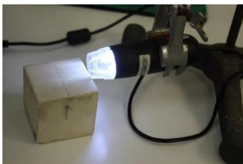
Εικόνα 9: Η πειραματική διάταξη που χρησιμοποιήθηκε για την μέτρηση της γωνίας επαφής σταγόνας - επιφάνειας
