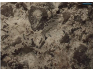
Εικόνες 73 - 74: Untreated - Treated δοκίμιο Ασβεστοκονιάματος
