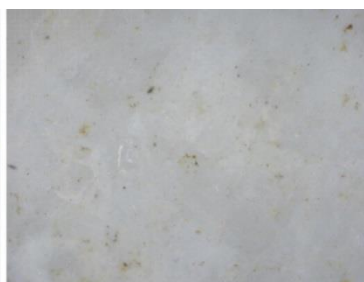
Εικόνες 93 - 94: Untreated - Treated δοκίμιο νέου Πεντελικού μαρμάρου με τεχνητή πάτινα
