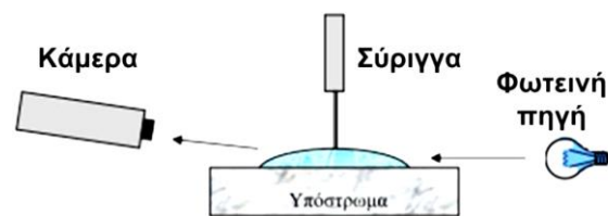
Εικόνα 7: Διάταξη φωτογράφισης της Contact Angle
