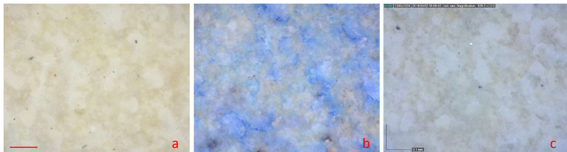
Εικόνες 124 (a - c): Treated δοκίμια AL πριν την εφαρμογή του MB, αμέσως μετά τον χρωματισμό και μετά την έκθεση στο UV
