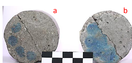
Εικόνες 116 (α – β): Untreated & Treated δοκίμια CEM αμέσως μετά την εφαρμογή του MB
