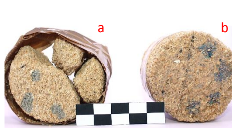
Εικόνες 114 (α – β): Untreated & Treated δοκίμια PRC αμέσως μετά την εφαρμογή του MB
