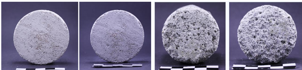
Εικόνες 57 – 58: Untreated - Treated δοκίμιο Υδραυλικού κονιάματος
