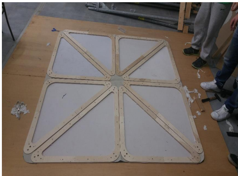
Εικ. 25 Ολοκληρωμένο μπλόκ τριγώνων επενδυμένα με λύκρα και ενωμένα με πάνινους συνδέσμους
