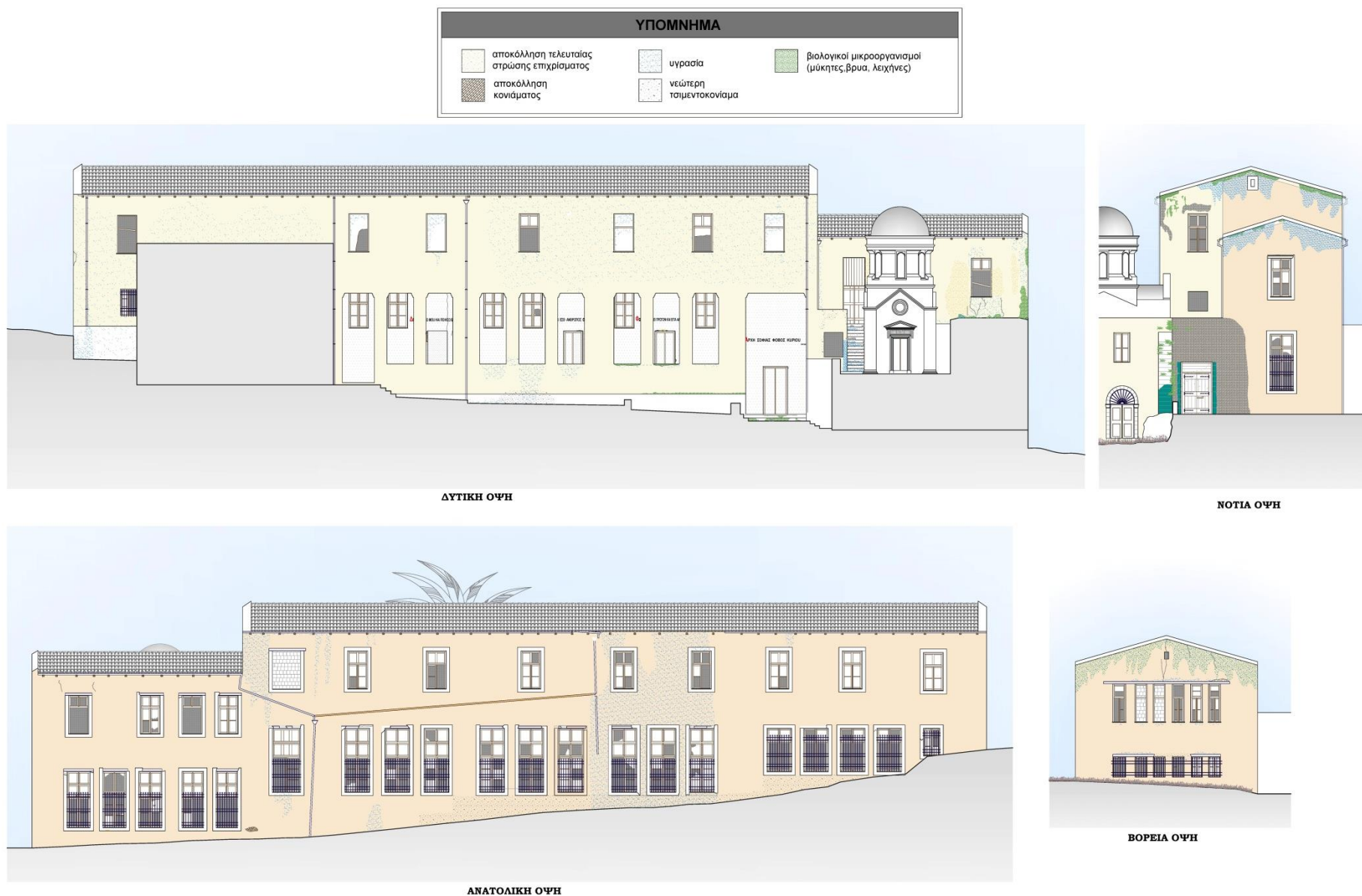
Σχ. 8 : Αποτύπωση φθορών στις όψεις της Ιερατικής Σχολής Αγίας Τριάδος
