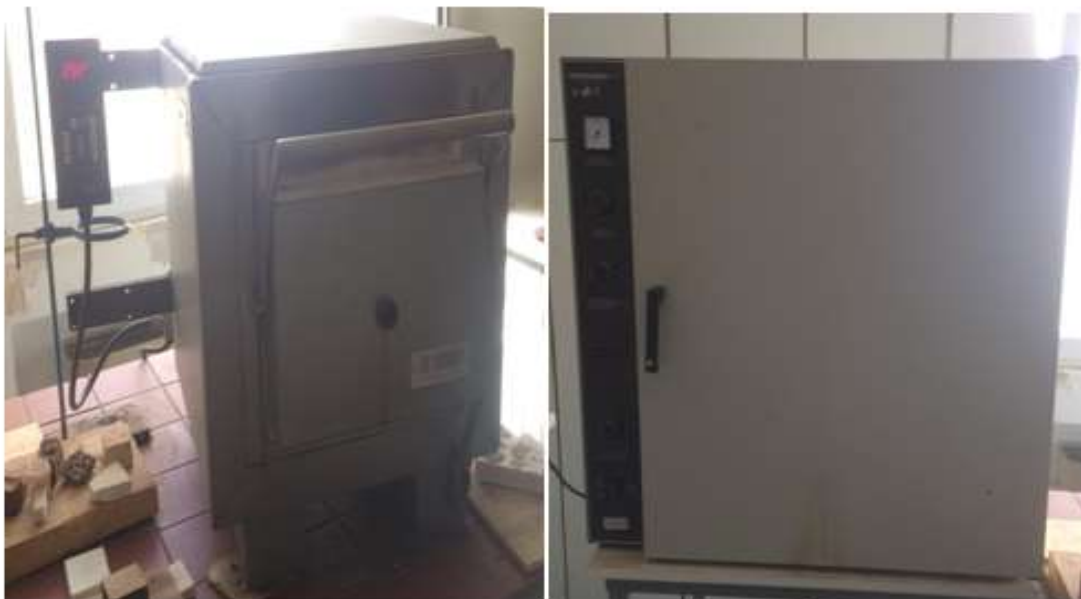
Εικόνα 2.3.2-2: Φούρνος έψησης δειγμάτων στους 250°C (αριστερή εικόνα) και ξηραντήριο τοποθέτησης δειγμάτων στους 105°C (δεξιά εικόνα), του Εργαστηρίου Γενικής και Τεχνικής Ορυκτολογίας της Σχολής Μηχανικών Ορυκτών Πόρων του Πολυτεχνείου Κρήτης .
