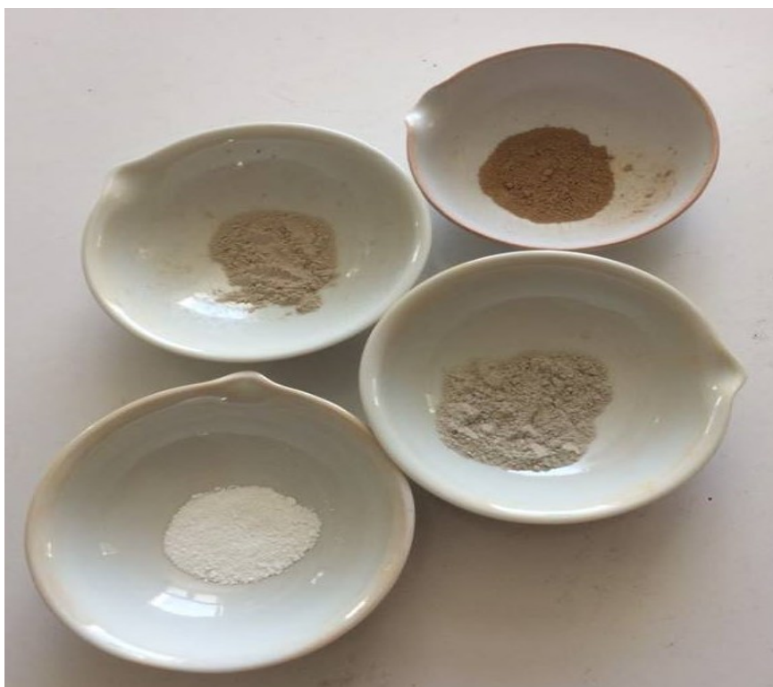
Εικόνα 2.3.2-1: Δείγματα και ZnO (κάτω αριστερά) τοποθετημένα σε κάψες για εισαγωγή στον φούρνο.
