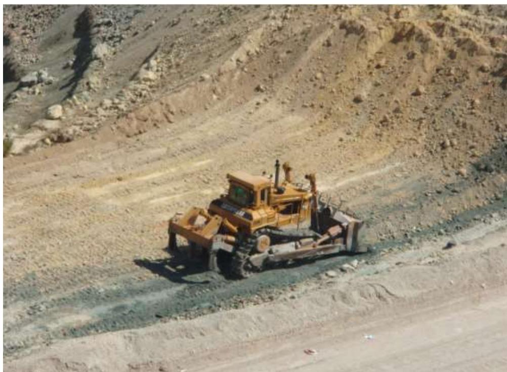
Εικόνα 1.7-1: Χωματουργικό μηχάνημα με χρήση αποξεστήρα στο πίσω μέρος, στο ορυχείο της Αγγερίας (Μήλος).
