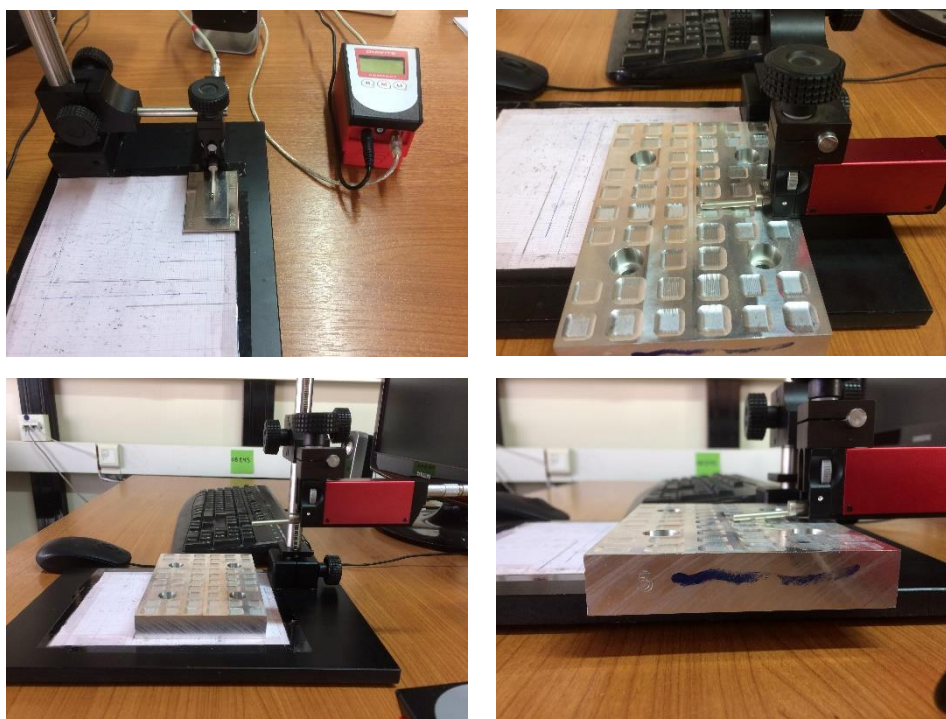
Σχήμα 4.10 Τραχυμετρήσεις με το Diavite Compact
