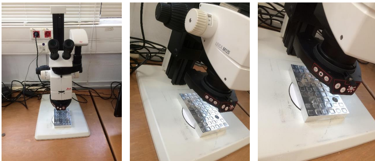
Σχήμα 4.12 Λήψη φωτογραφίας από το στεροσκόπιο
