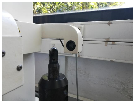
Σχήμα 4.5 Μέτρηση του εργαλείου σφαιρικής απόληξης D=20\text{mm}
