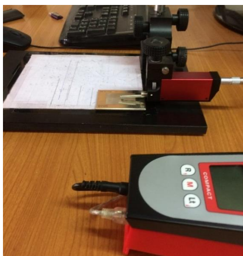
Σχήμα 4.9 Καλιμπράρισμα τραχύμετρου
