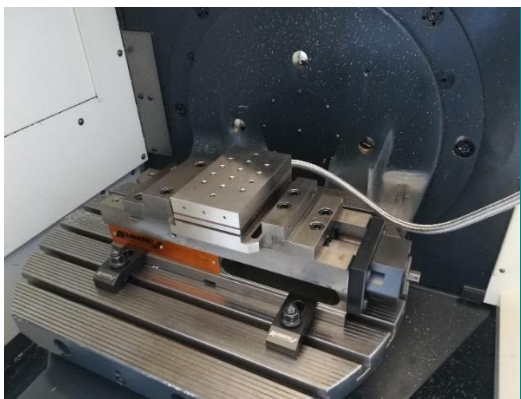
Σχήμα 4.6 Το δυναμόμετρο τοποθετημένο στη μέγγενη
