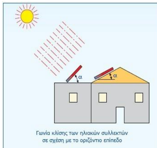
Εικόνα 2.8 Γωνία κλίσης των ηλιακών συλλεκτών
