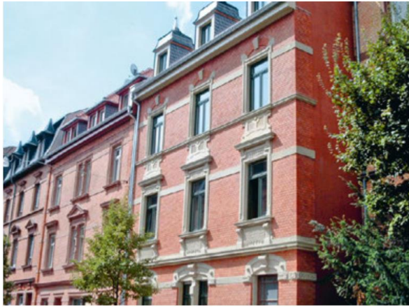
Εικόνα 62: Ενεργειακή αναβάθμιση ιστορικού κτιρίου με εσωτερική θερμομόνωση στην πρόσοψη και εξωτερική στην πίσω όψη. Η ανάγκη για θέρμανση μπορεί να μειωθεί έως και 80% χωρίς να αλλοιωθούν τα αρχιτεκτονικά χαρακτηριστικά του κτιρίου[39]
